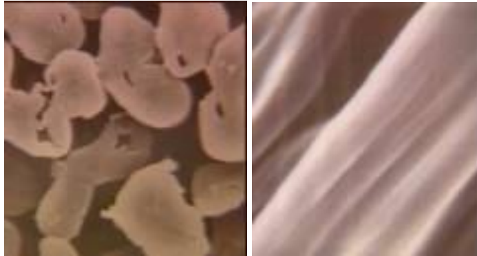
Şekil 2.8: Soya Lifinin Enine ve Boyuna Kesit Görüntüleri
