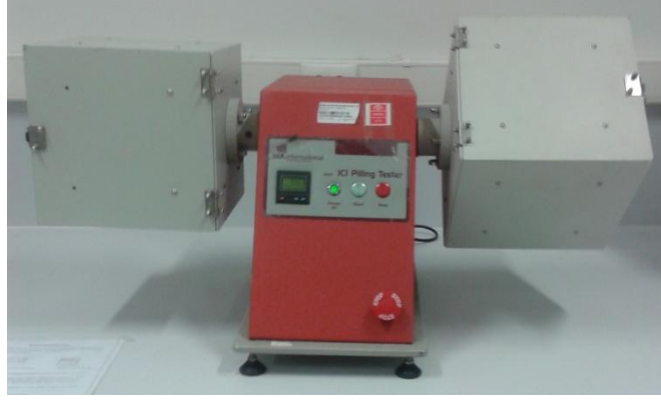
Şekil 3.6: Boncuklanma test cihazı
