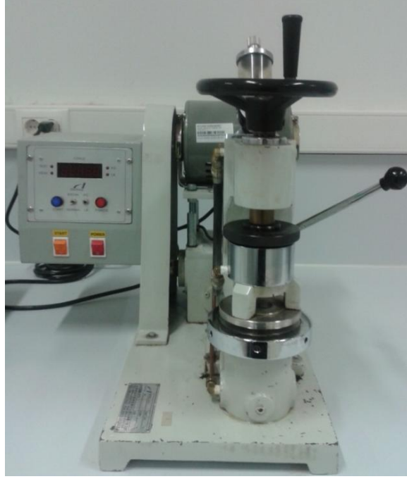
Şekil 3.5: Patlama mukavemeti ölçüm cihazı
