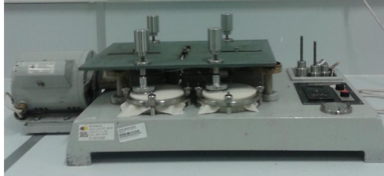
Şekil 3.7: Aşınma dayanımı test cihazı
