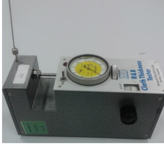
Şekil 3.4: Kalınlık ölçüm cihazı
