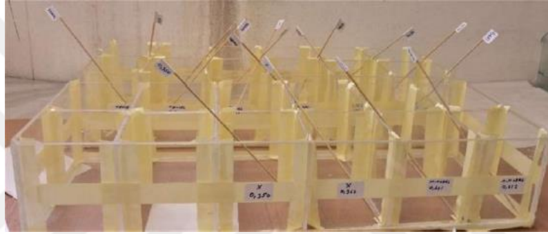
Şekil 2.8 Toprak gömme testi için yaptırılan düzenek (Kişisel arşiv, 2018)
