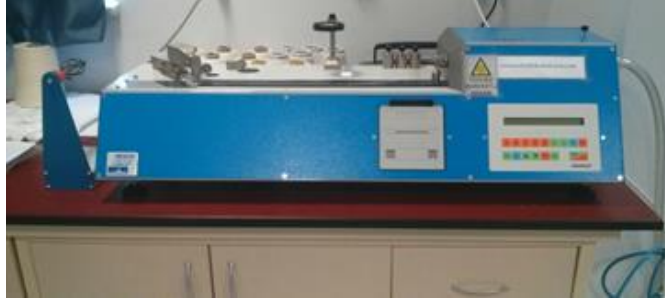
Şekil 2.2 Mesdan otomatik büküm ölçeri (Kişisel arşiv, 2018)
