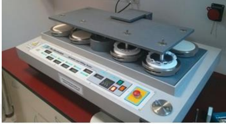
Şekil 2.5 Nu- Martindale boncuklanma ve aşınma ölçeri (Kişisel arşiv, 2018)
