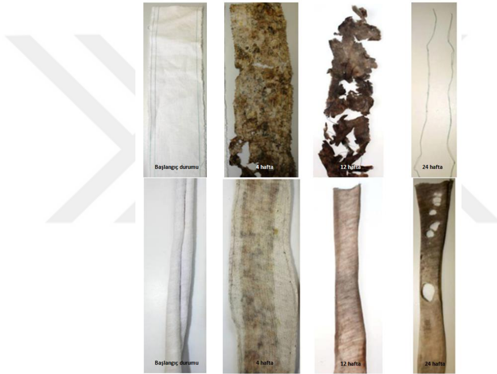
Şekil 1.14 a) Kontrol kumaşında bozunma davranışı b) karışım kumaşta bozunma davranışı (Alay ve Duran, 2016)
