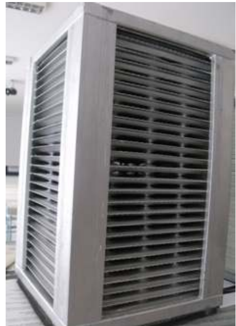
Şekil 7.5.b. Alüminyum ısı değıştirici yandan görünüş.
