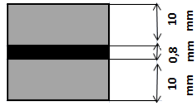
Şekil 7.4.b. Alüminyum ısı değıştirici kanal aralıkları.
