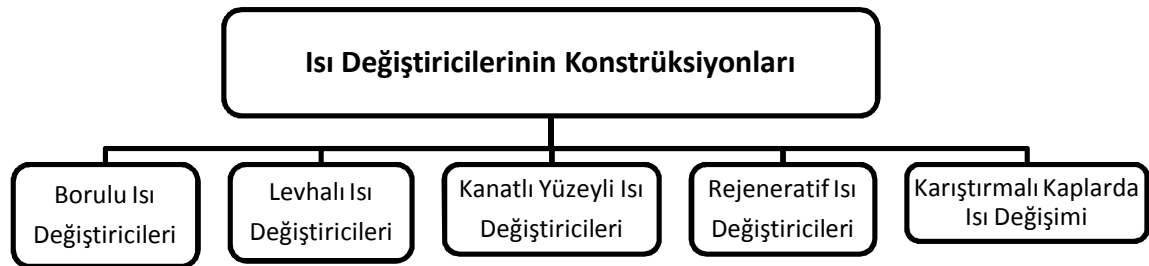
Şekil 3.1. Isı değıştircilerinin konstrüksiyonları. (Yakut, 2007)
