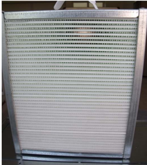
Şekil 7.7.a. Polimer ısı değıştirici önden görünüş.
