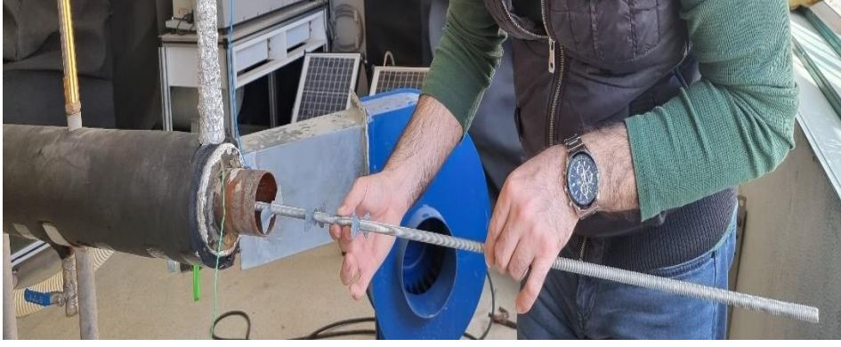
Şekil 4.2. Türbülatorlerin tij üzerindeki dizilimi ve sisteme yerleştirilmesi
