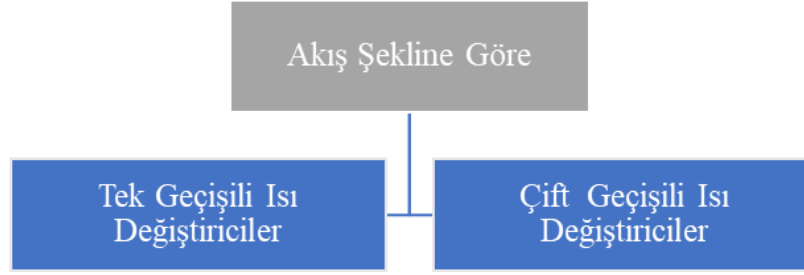
Şekil 3.5. Akış şekline göre ısı değiştiricileri (Karaali, 2002)
