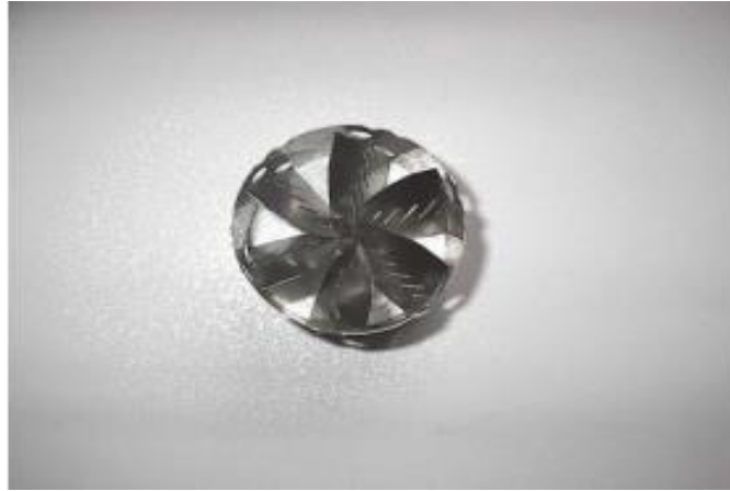
Şekil 2.3. Türbülatorün üstten görünüşü (Arguhan ve Yıldız, 2006)
