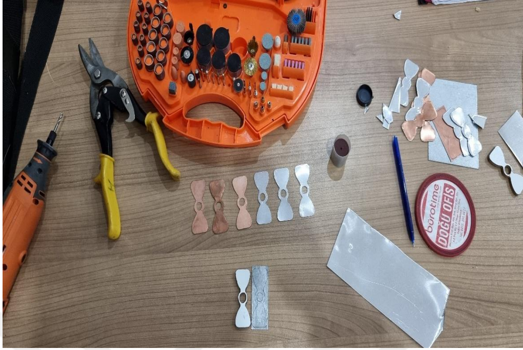
Şekil 4.11. Deney düzeneğinde kullanılan türbülatorlerin imalat görseli
