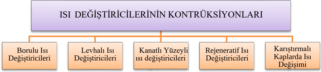
Şekil 3.12. Isı değiştiricilerin yapılarına göre sınıflandırılması (Karaali, 2009)
