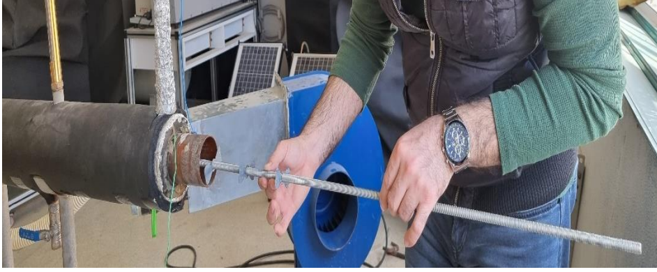
Şekil 4.2. Türbülatorlerin tij üzerindeki dizilimi ve sisteme yerleştirilmesi
