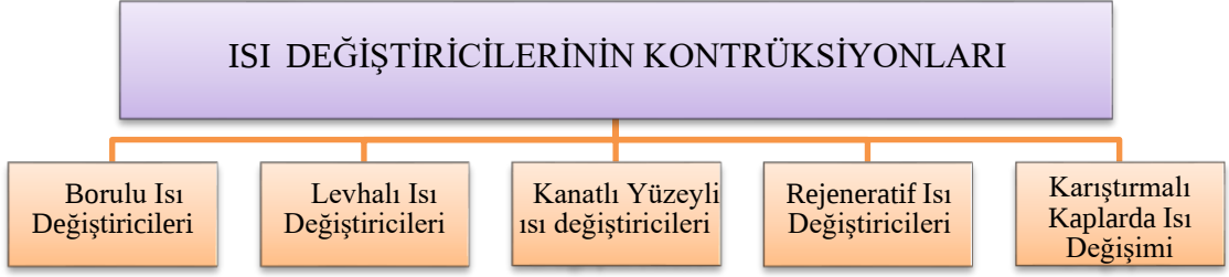
Şekil 3.12. Isı değiştiricilerin yapılarına göre sınıflandırılması (Karaali, 2009)
