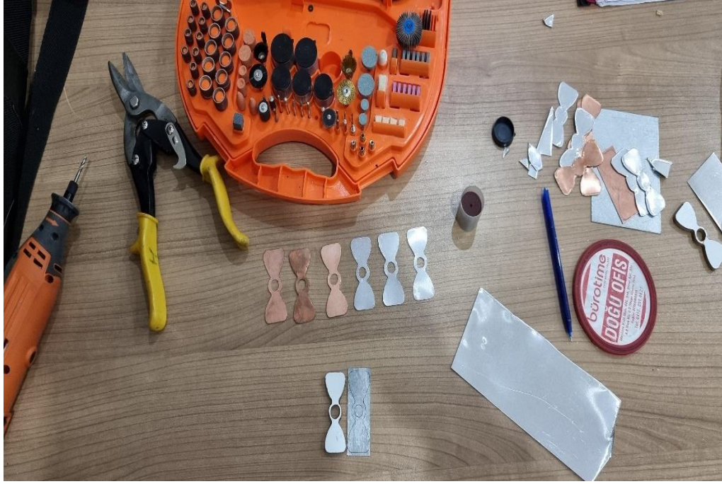
Şekil 4.11. Deney düzeneğinde kullanılan türbülatorlerin imalat görseli
