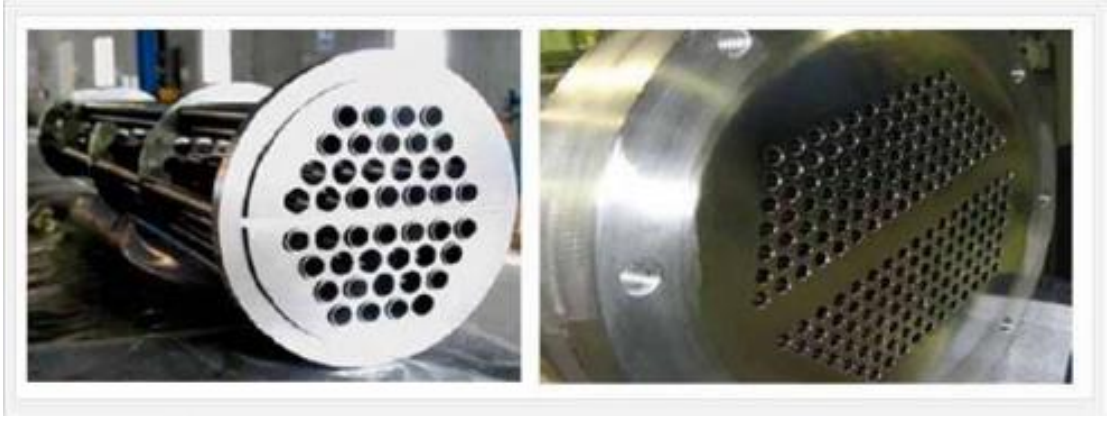
Şekil 3.14. Borulu ısı değiştiricilerinde boru (tüp) demeti ve aynası (Aydın, 2014)
