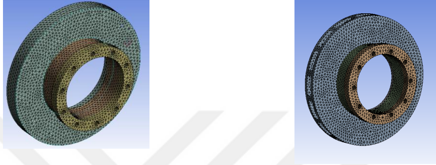
Şekil 3.2. Havalandırılmalı ve havalandırmasız disk için FEA Modeli mesleme
