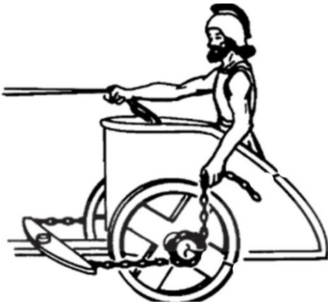
Şekil 1.2. Romalıların kullandığı fren sistemi
