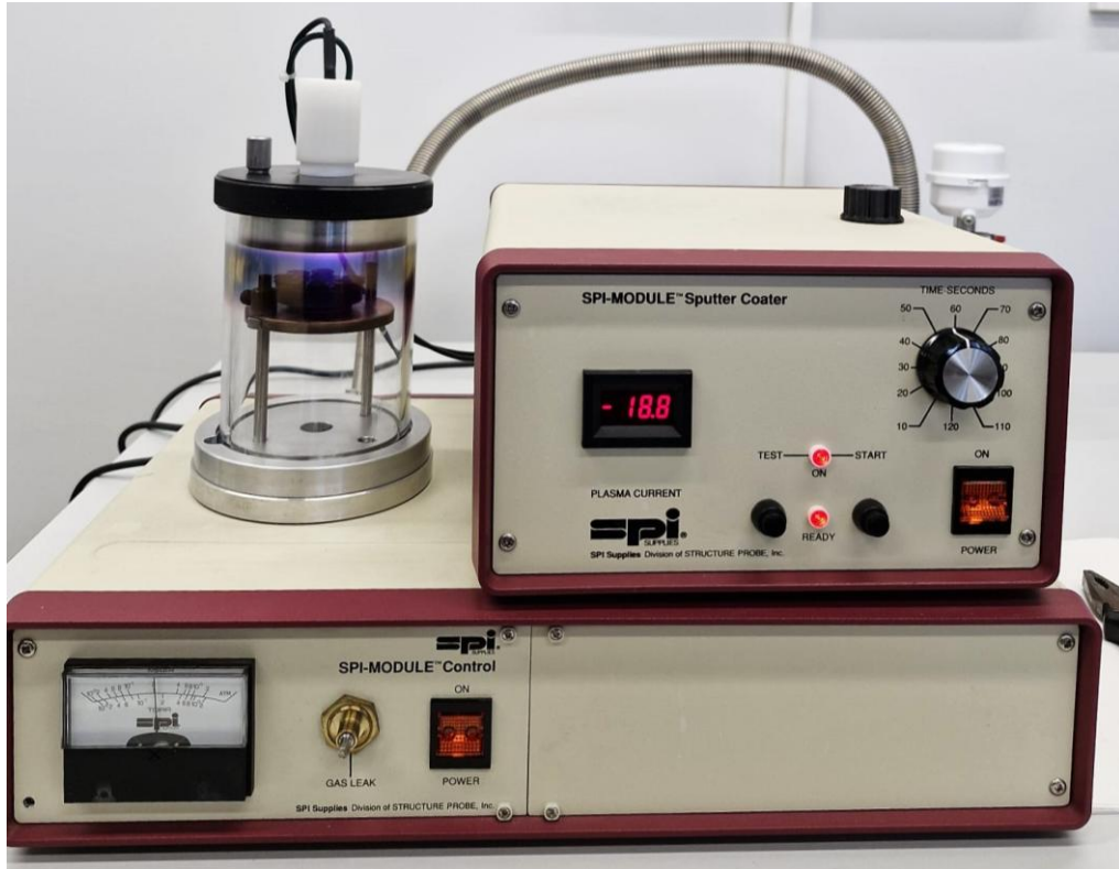
Şekil 7. Numunelere püskürtme kaplama işlemi yapılırken
