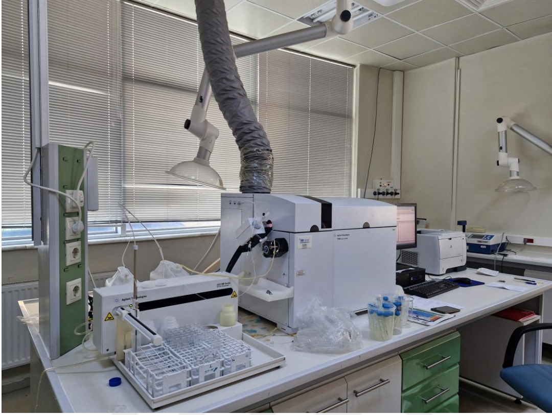
Şekil 11. Element analizlerinin yapıldığı ICP-MS cihazı (Agilent 7700 Serisi)
