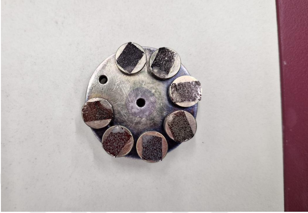
Şekil 8. Numunelerin Altın/Paladyum kaplaması yapıldıktan sonra
