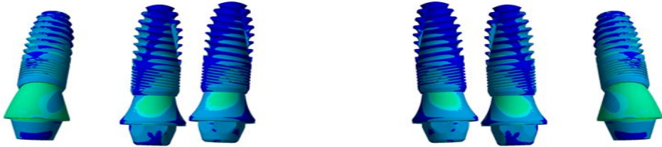
Şekil 4.7. Model 2-Titanyum için implant çevresinde oluşan Von Mises stresleri
