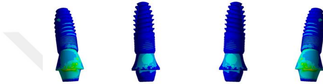
Şekil 4.2. Model 1-Zirkonya için implant çevresinde oluşan Von Mises stresleri
