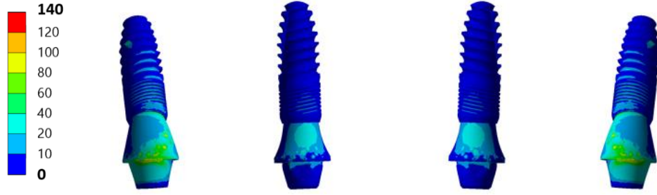
Şekil 4.1. Model 1-Cr-Co için implant çevresinde oluşan Von Mises stresleri
