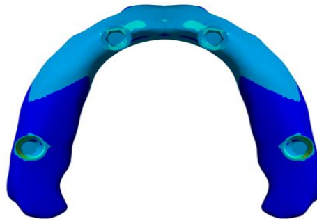
Şekil 4.12. Model 1-PEEK alt yapıda oluşan Maksimum Von Mises stresleri
