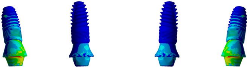
Şekil 4.4. Model 1-PEEK için implant çevresinde oluşan Von Mises stresleri
