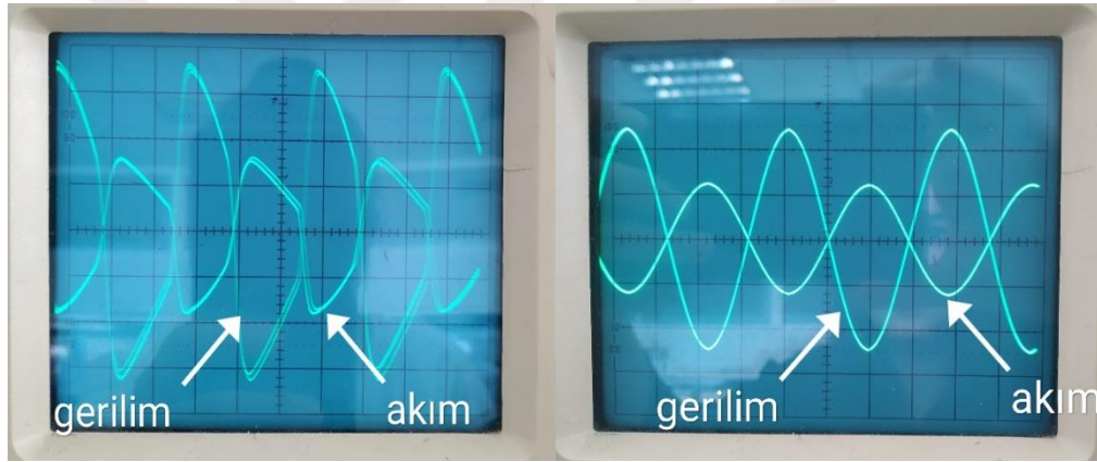
Şekil 4. 35 : Alharbi ve diğ gerilim kontrollü emülatörlü (solda) ve standart dirençli (sağda) osilatörlerin ölçülen akım- gerilim değerleri.
