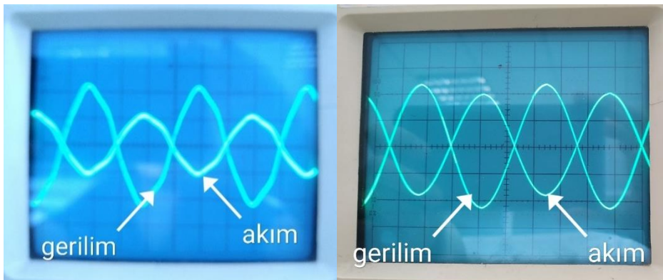
Şekil 4. 31 : Muthuswamy emülatörlü (solda) ve standart dirençli (sağda) osilatörlerin ölçülen akım- gerilim değerleri.
