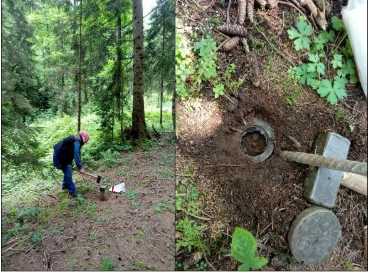
Şekil 14. Kök örneklerinin silindir ile alınması
