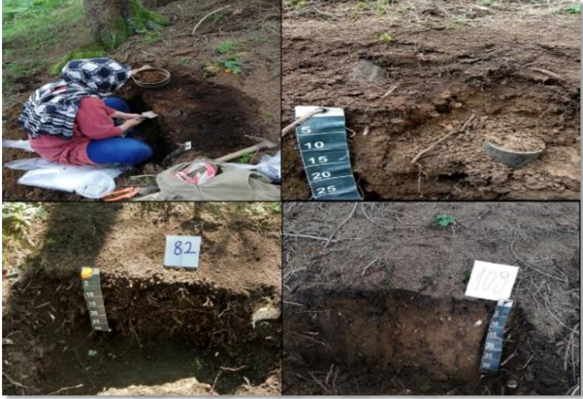
Şekil 16. Toprak profillerinin açılması ve örnek alımı
