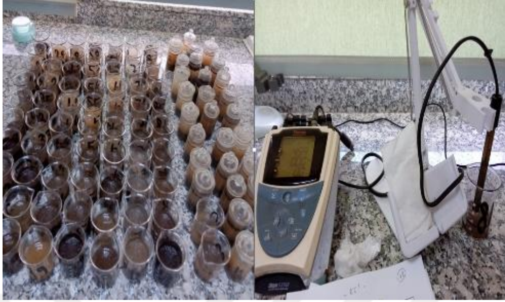
Şekil 25. Toprak örneklerinde pH belirlenmesi
