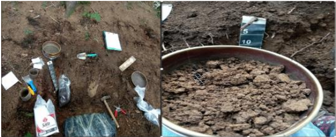
Şekil 17. Amonyum ve Nitrat tayini için toprak örneklerinin alınması
