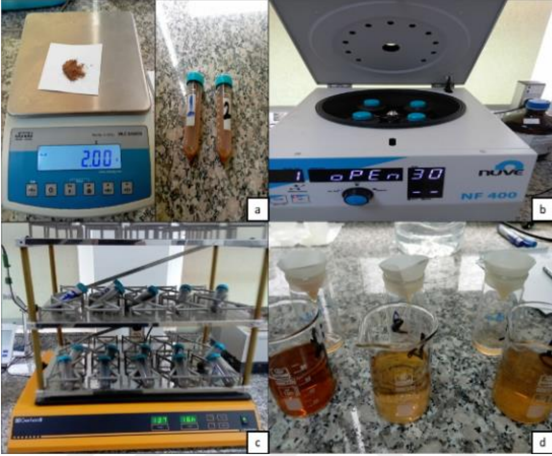
Şekil 29. Toprak örneklerinde Amino asit analizi ekstraksiyon aşaması (a: Toprak örneklerinin tartılması, b: Toprak çözeltisinin santrifüj edilmesi, c: Örneklerin çalkalanma aşaması, d: Örneklerin filtre kâğıdından süzülmesi)
