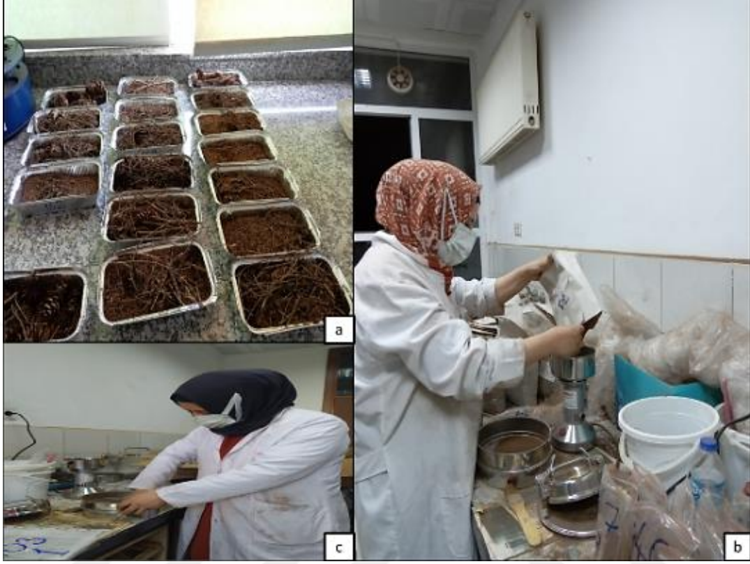
Şekil 19. Ölü örtü örneklerinde yapılan işlemler (a: Örneklerin fırın kurusu hale getirilmesi, b: Örneklerin öğütülmesi, c: Örneklerin elekten geçirilmesi)
