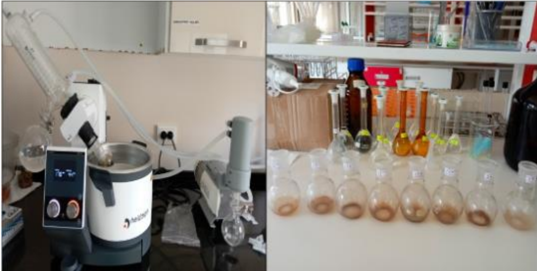
Şekil 30. Toprak örneklerinin rotary evaporatörde buharlaştırılması
