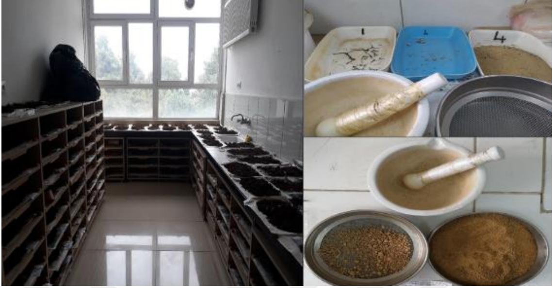
Şekil 23. Toprak örneklerinin hava kurusu hale getirilmesi ve öğütülerek elekten geçirilmesi
