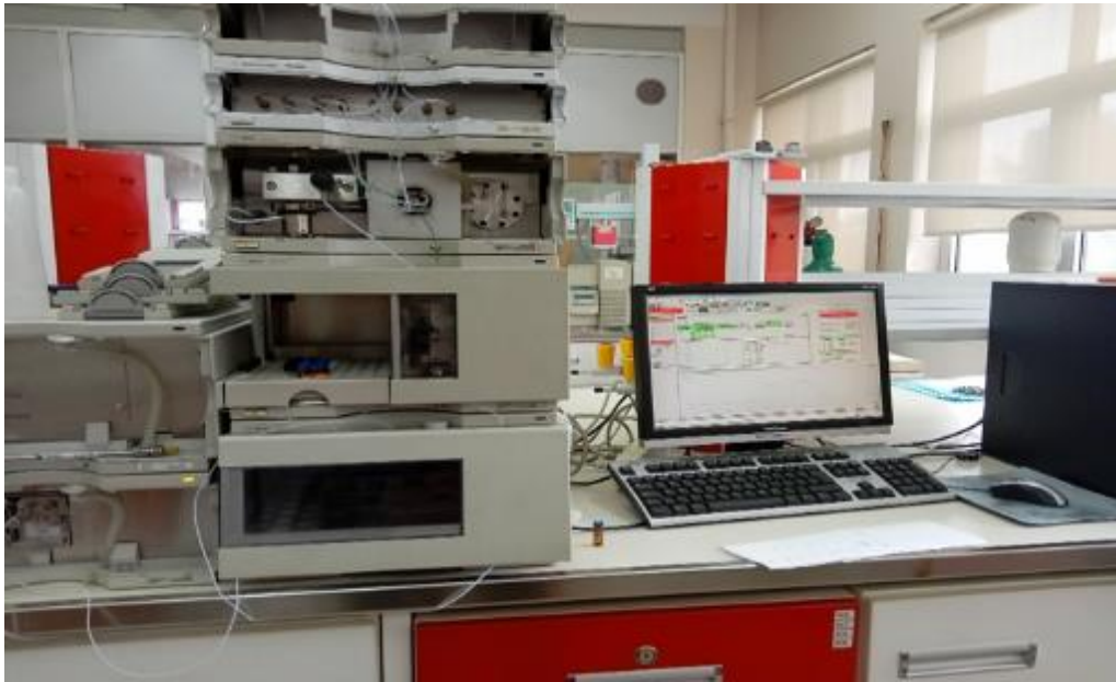
Şekil 32. Toprak örneklerinde HPLC ile amino asit tayini
