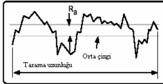
Şekil 2-14. R_a yüzey pürüzlülük diyagramı (Yeniyol, 2006)
