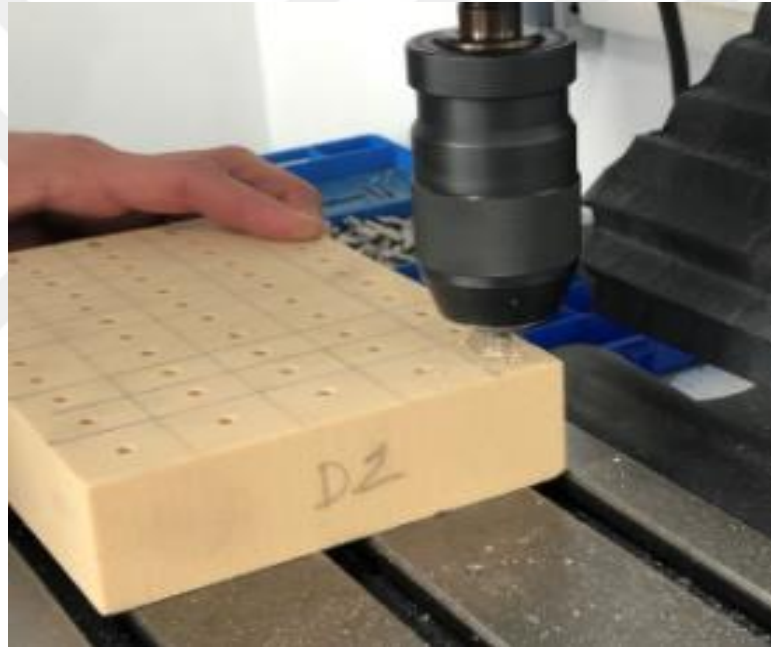
Şekil 3-5. Optimum® Bf 20 Vario Freze tezgahında sawbones kemik blokları üzerinde implant yuvasının hazırlanması
