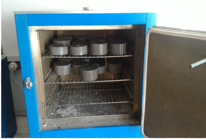
Şekil 2.40. Kılcallık deneyi numuneler kurutmak için kullanılan etüv
