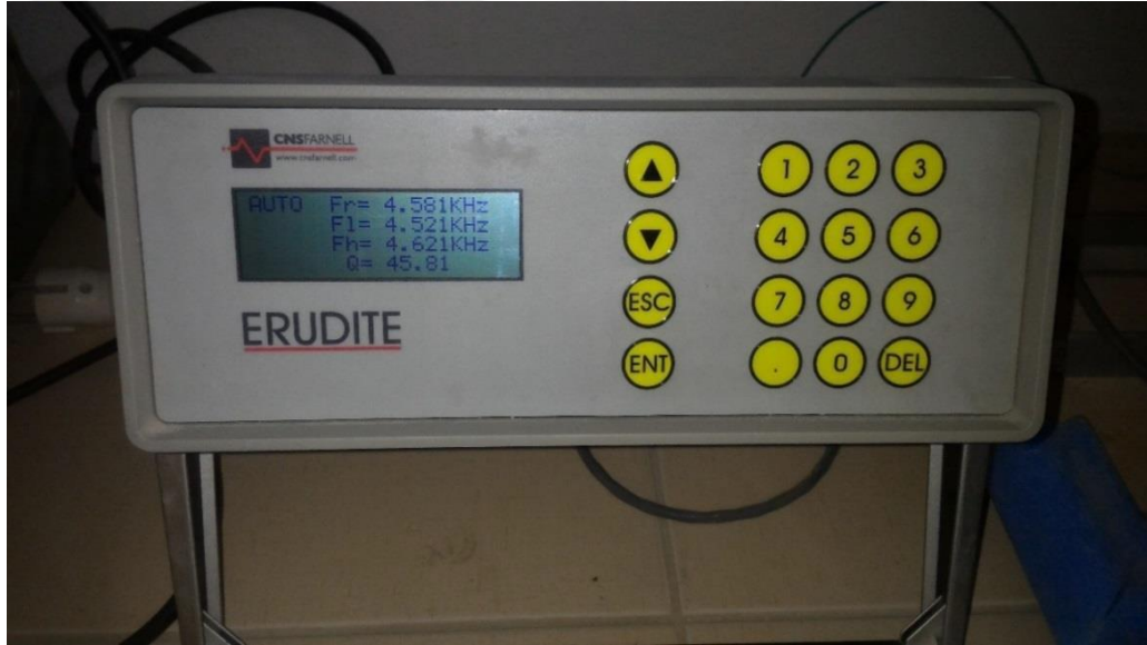
Şekil 2.30. Rezonans frekans deney kontrol ünitesinde ekran görüntüsü
