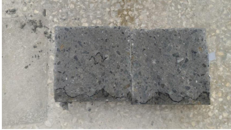
Şekil 2.38. Yarma işlemi sonrası su işleme seviyesinin belirlenmesi
