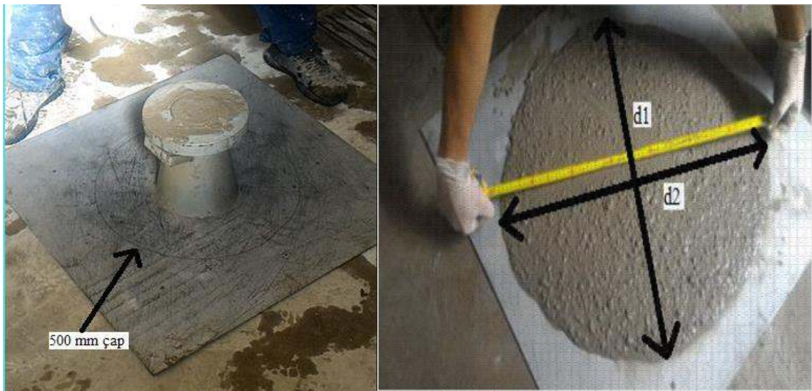
Şekil 2.21. T_{500} ve çökme-yayılmanın ölçülmesi
