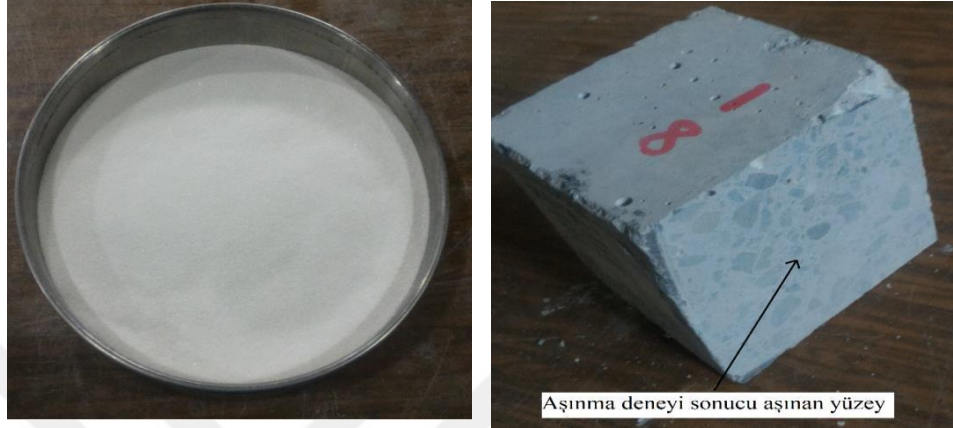
Şekil 2.28. Zımpara (korundum) tozu ve aşınan deney numunesi
