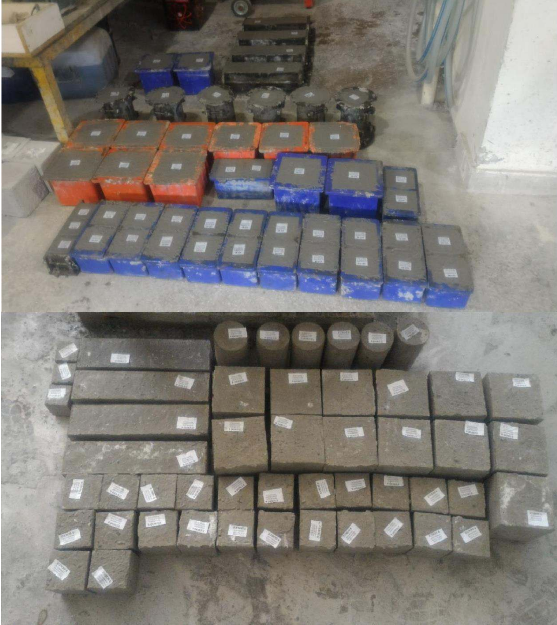
Şekil 2.19. Tek üretimde denenmek üzere hazırlanan KYB numuneler
