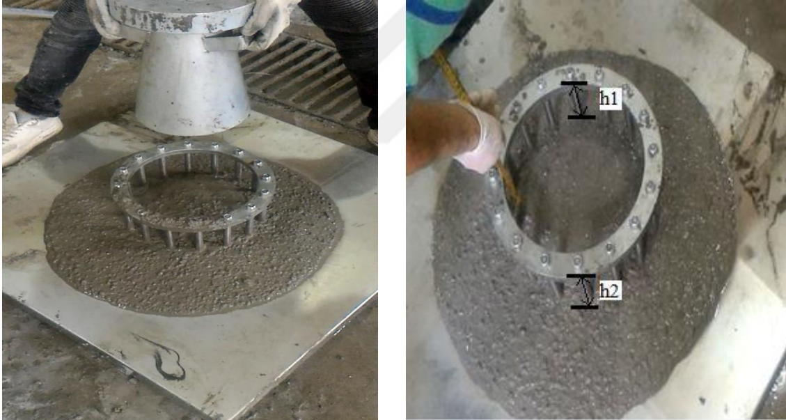
Şekil 2.22. J halkası deneyinin gerçekleştirilmesi
