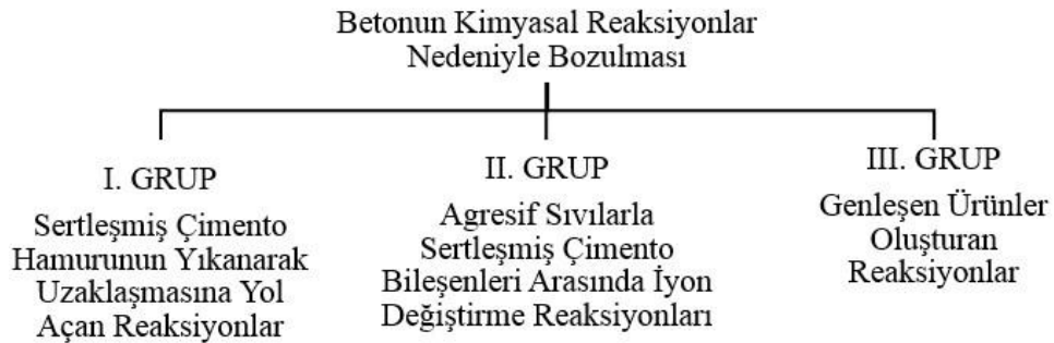
Şekil 1.12. Betonun kimyasal bozulma nedenleri [147]
