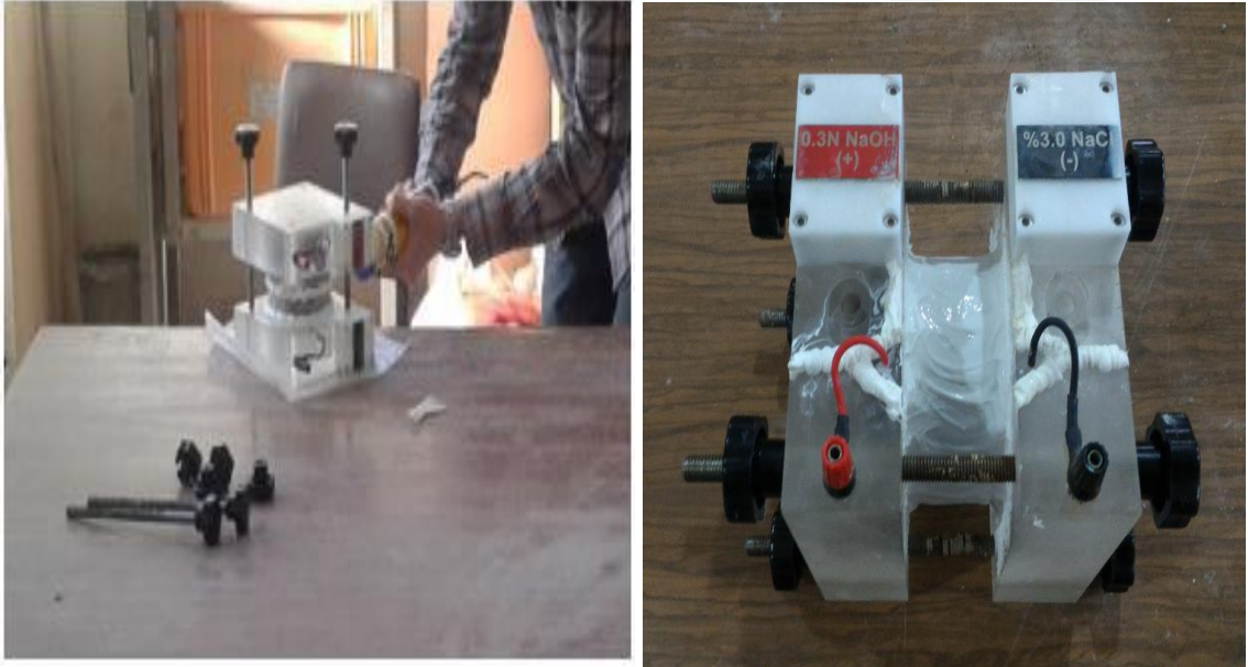
Şekil 2.34. Hızlı klorür geçirirlik deneyi hazırlama aşaması
