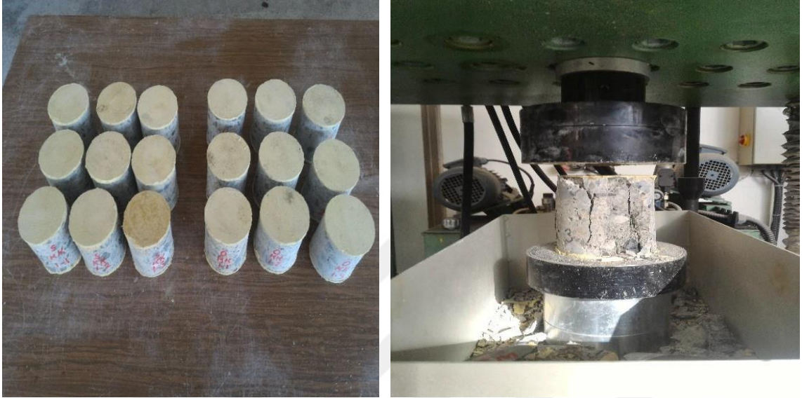
Şekil 2.7. Başlıklanmış karot numuneler ve basın dayanımı deneyinin gerçekleştirilmesi
