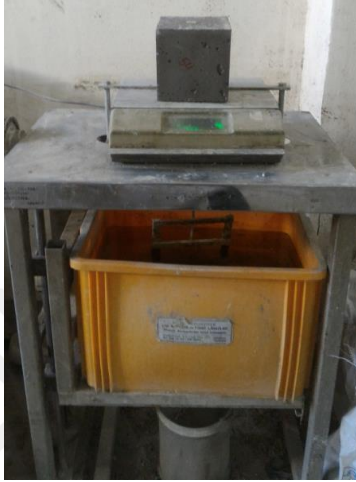
Şekil 2.43. Birim ağırlığı belirlemede kullanılan Arşimet terazisi
