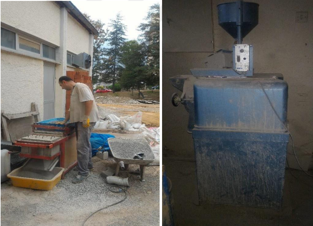
Şekil 2.8. Agregaya eleme cihazı (solda) ve öğütme cihazı (sağda)
