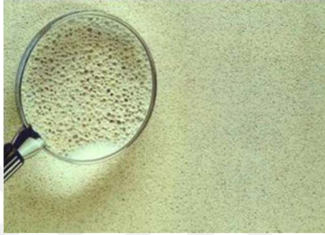
Şekil 2.1. Gazbetonun gözenekli yapısı (Ertokat, n., 2014, “Ytong Kitabı” Türk Ytong San A.Ş.).
