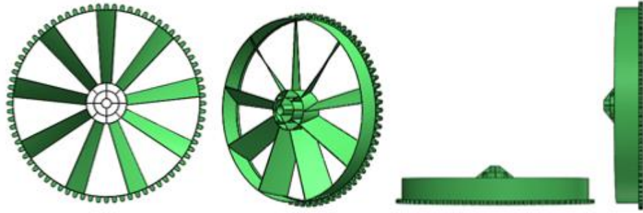
Şekil 5.82 300 mm - 9 kanatlı türbin (ön, perspektif, üst ve yan görünüş)
