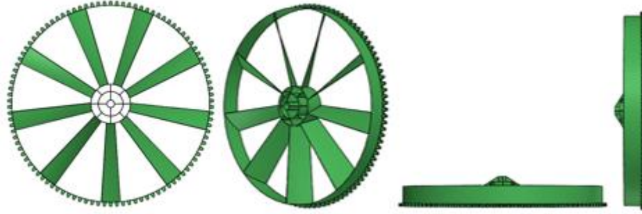
Şekil 5.127 400 mm - 9 kanatlı türbin (ön, perspektif, üst ve yan görünüş)
