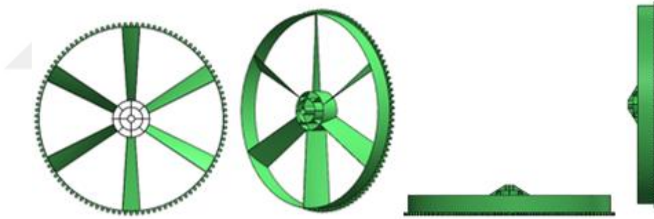
Şekil 5.114 400 mm - 6 kanatlı türbin (ön, perspektif, üst ve yan görünüş)
