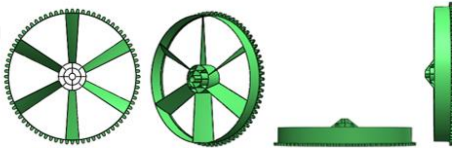
Şekil 5.69 300 mm - 6 kanatlı türbin (ön, perspektif, üst ve yan görünüş)
