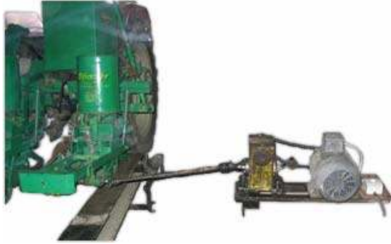
Şekil 8. Sonsuz yapışkan bantta mekanik ekim makinası ile çalışmada tohum dağılım düzgünlüğünün belirlenmesi
