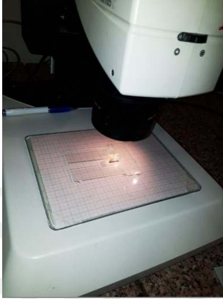
Resim 3. 15. Blokların sabit bir pozisyonda görüntülenmesi için hazırlanmış düzenek
