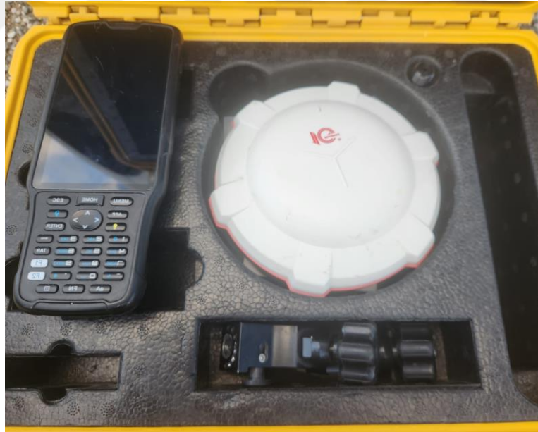
Şekil 4.2. Sino GNSS T300 Plus ölçüm cihazı.
