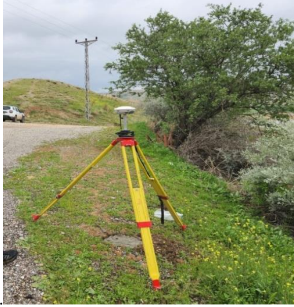
Şekil 7.3. Sabit RTK kurma.
