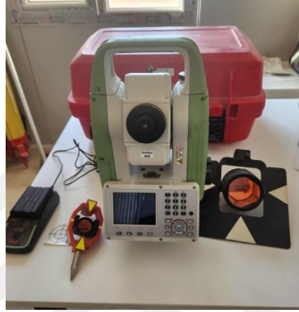
Şekil 5.1. Leica TS07 total station ölçüm cihazı.
