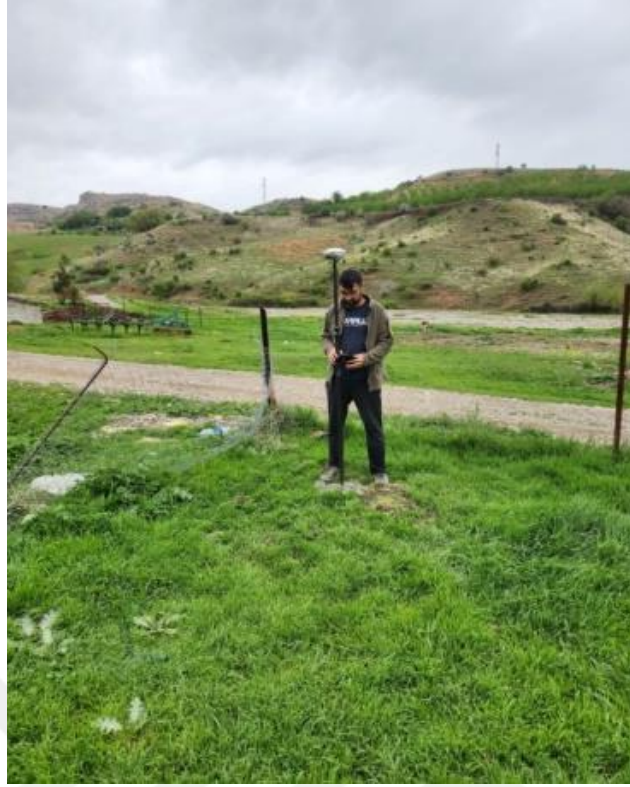
Şekil 7.4. Gezici GNSS ile epoklu ölçüm.
