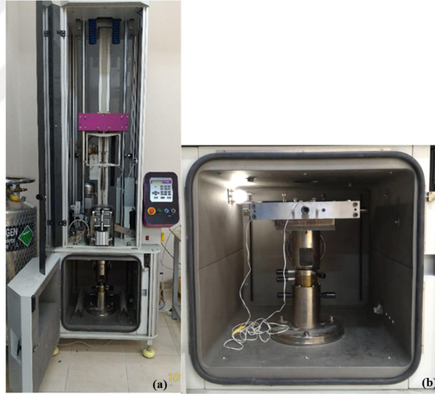
Şekil 4.4 a) Çalışmada kullanılan darbe cihazı ve b) ön yükleme aparatı (Kişisel arşiv, 2018)
