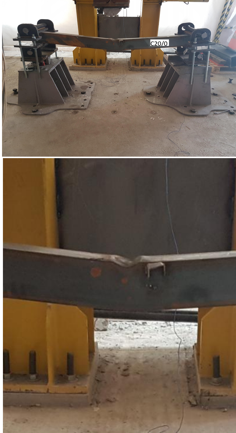
Şekil 5.4. C20D deformasyon gösterimi
