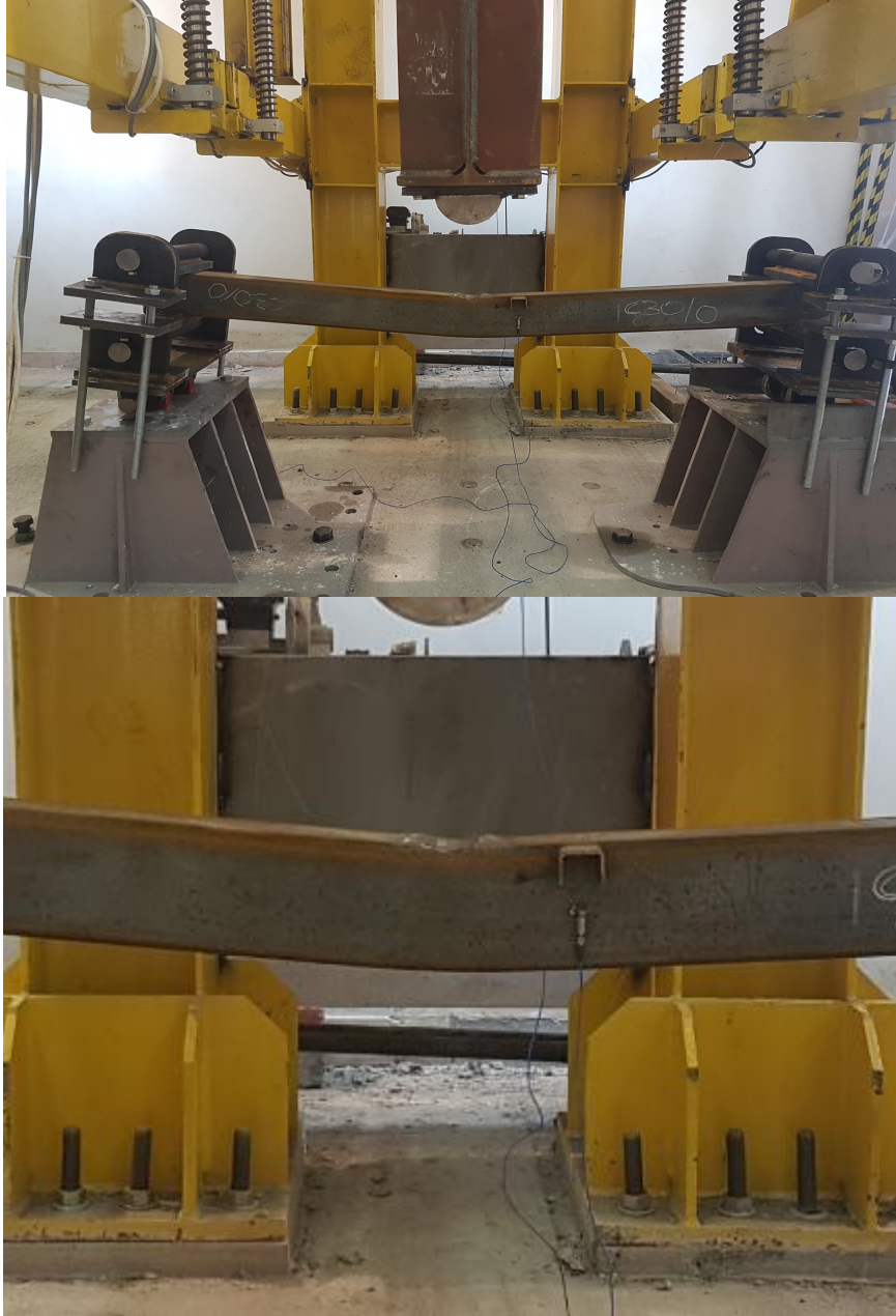
Şekil 5.11. C30D deformasyon gösterimi
