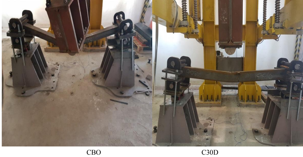
Şekil 6.1. CBO ve C30D numune deformasyon durumları
