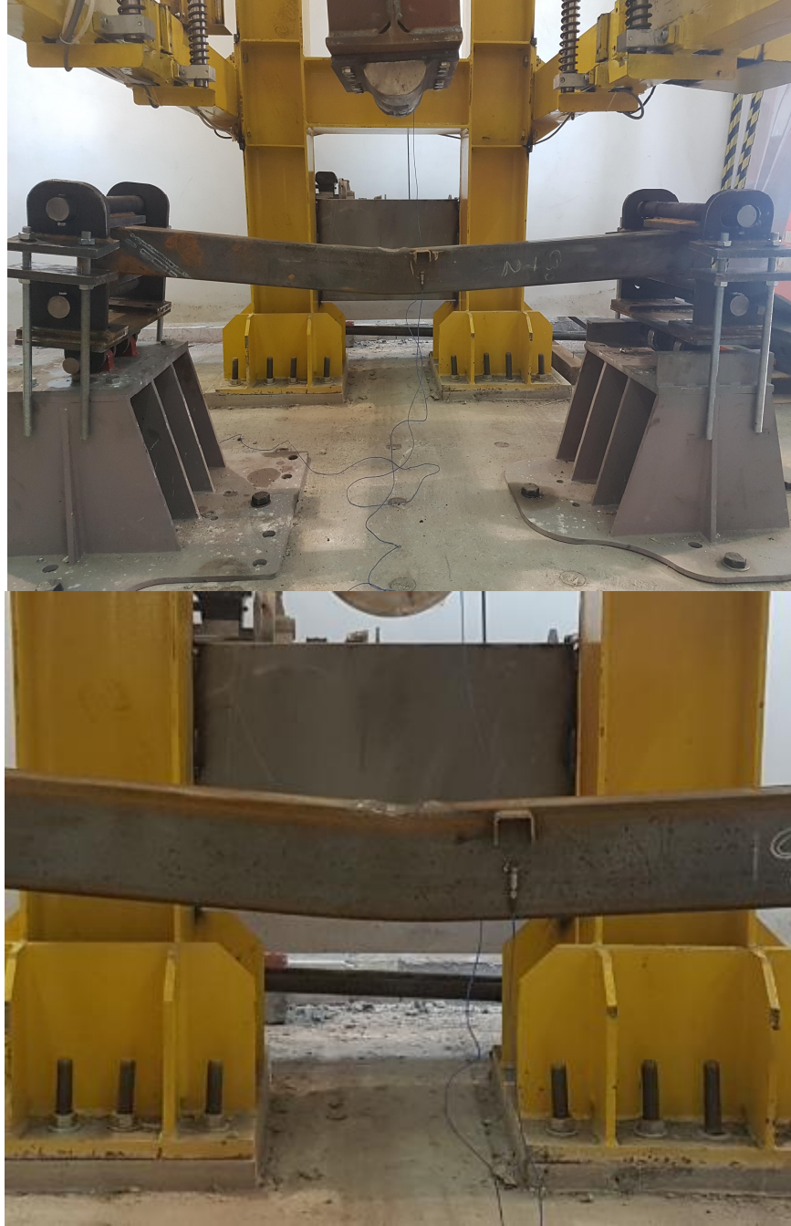
Şekil 5.12. C30MİD deformasyon gösterimi
