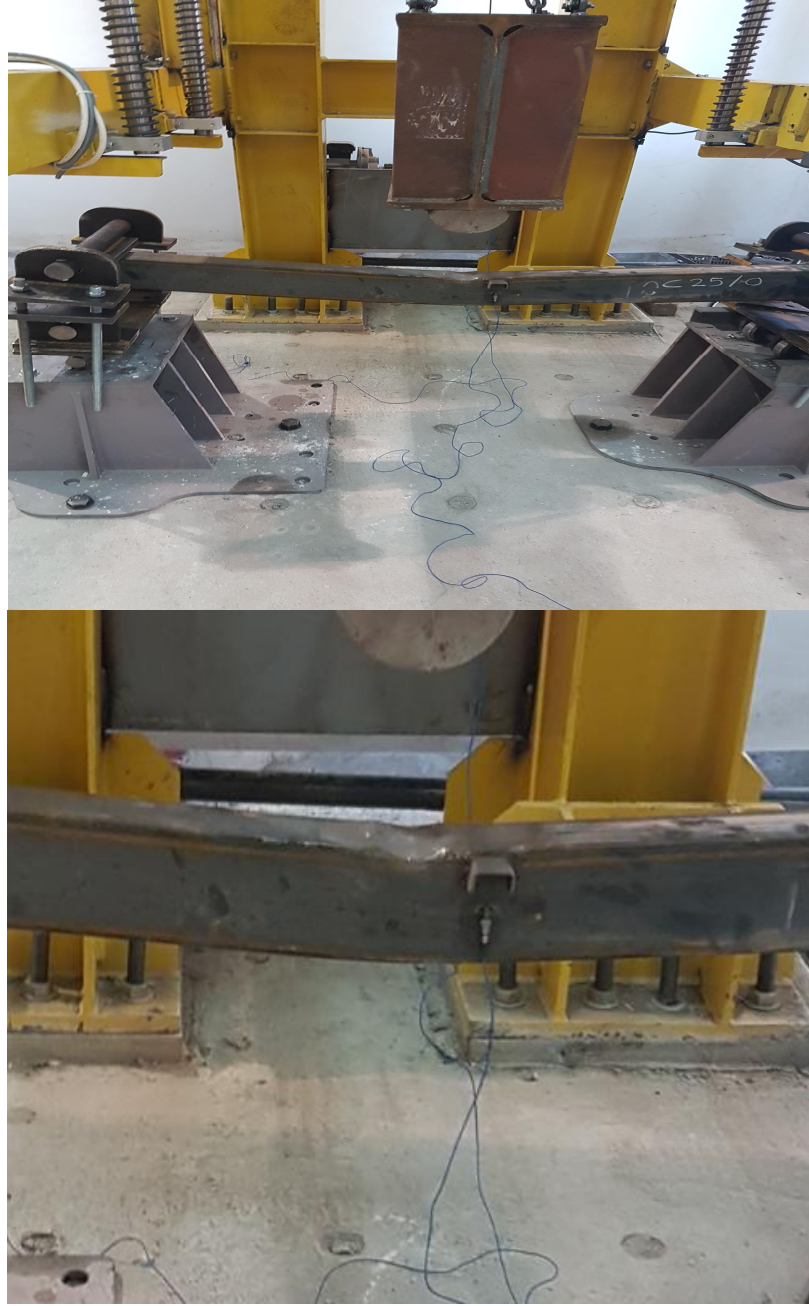
Şekil 5.8. C25D deformasyon gösterimi
