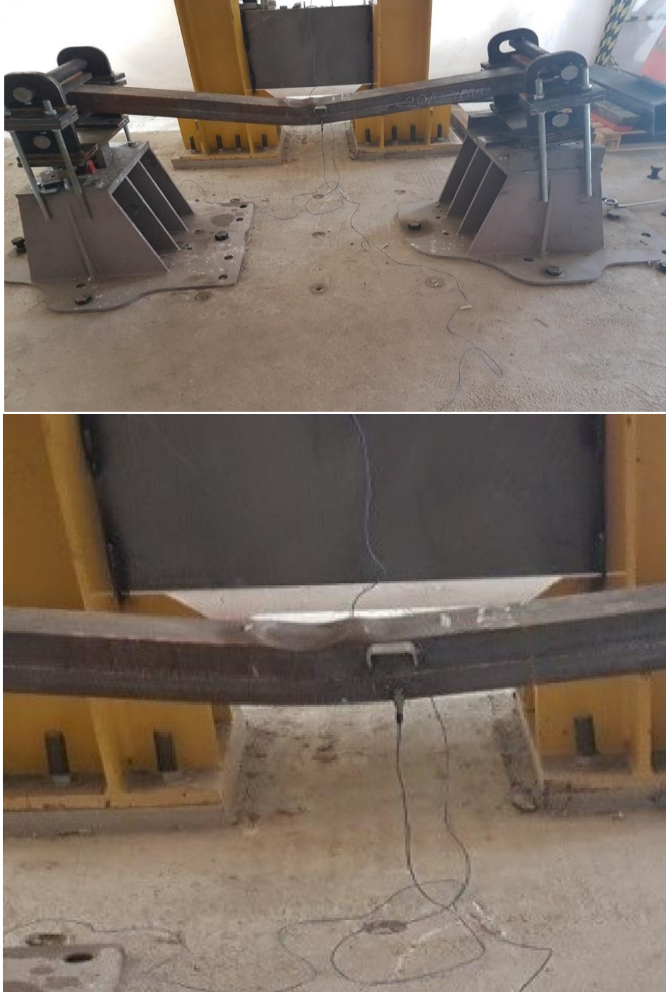
Şekil 5.3. C20T deformasyon gösterimi
