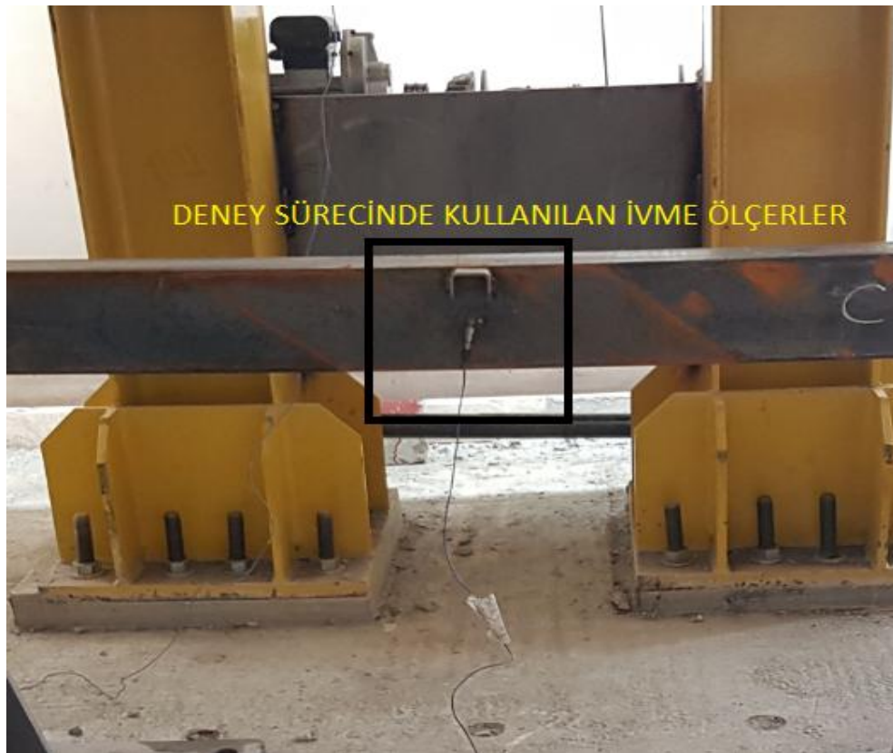
Şekil 4.14. Numune üzerine monte edilmiş ivme ölçerler
