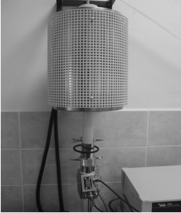
Resim 3.6. Yüksek sıcaklık numune tutucusunun fırın içine yerleştirilmesi.
