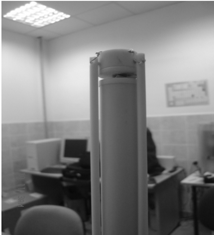
Resim 3.5. Yüksek sıcaklık numune tutucusu
