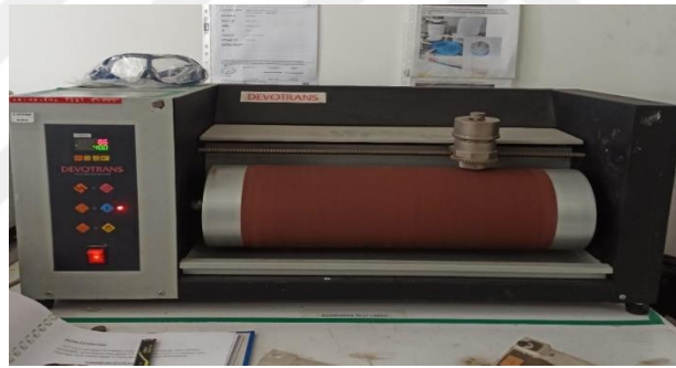
Şekil 6.22. Aşınma Testi Ölçüm Cihazı
