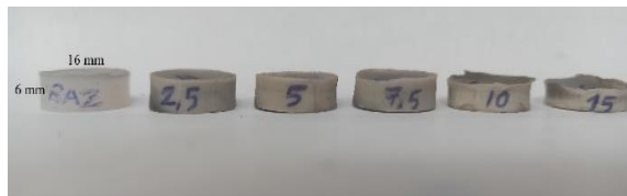
Şekil 6.23. Aşınma test numuneleri
