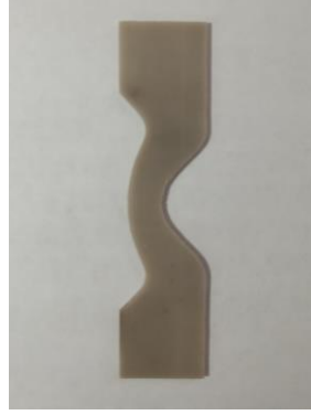
Şekil 6.15. Yırtılma testi numunesi
