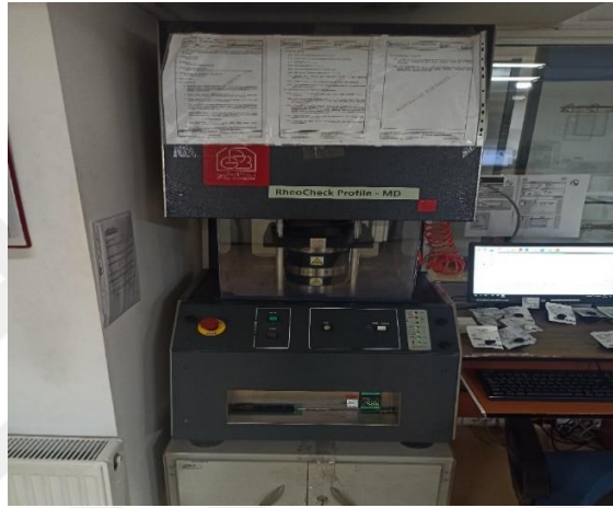
Şekil 6.7. Rheometre (kürlenme süresi tayin) cihazı
