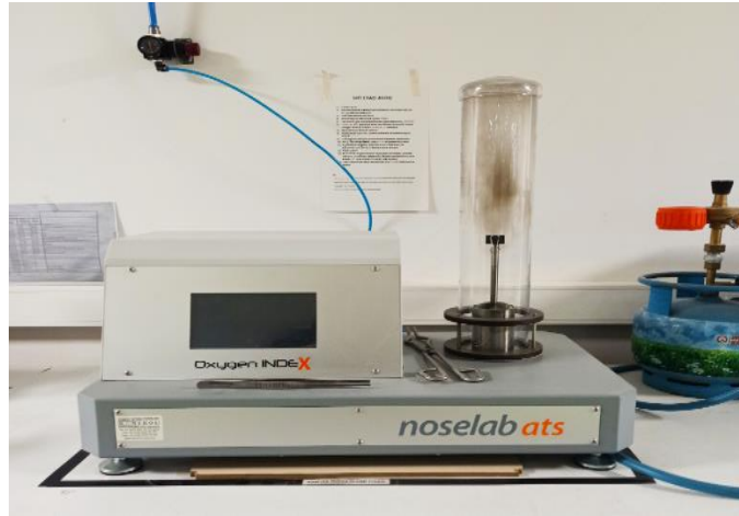
Şekil 6.16. LOI test cihazı
