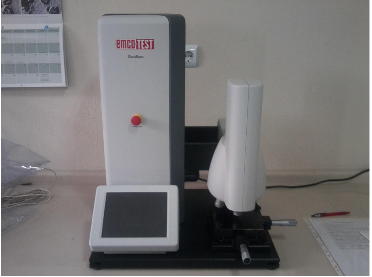
Şekil 5.6. Emtotest Durascan sertlik ölçüm cihazı.
