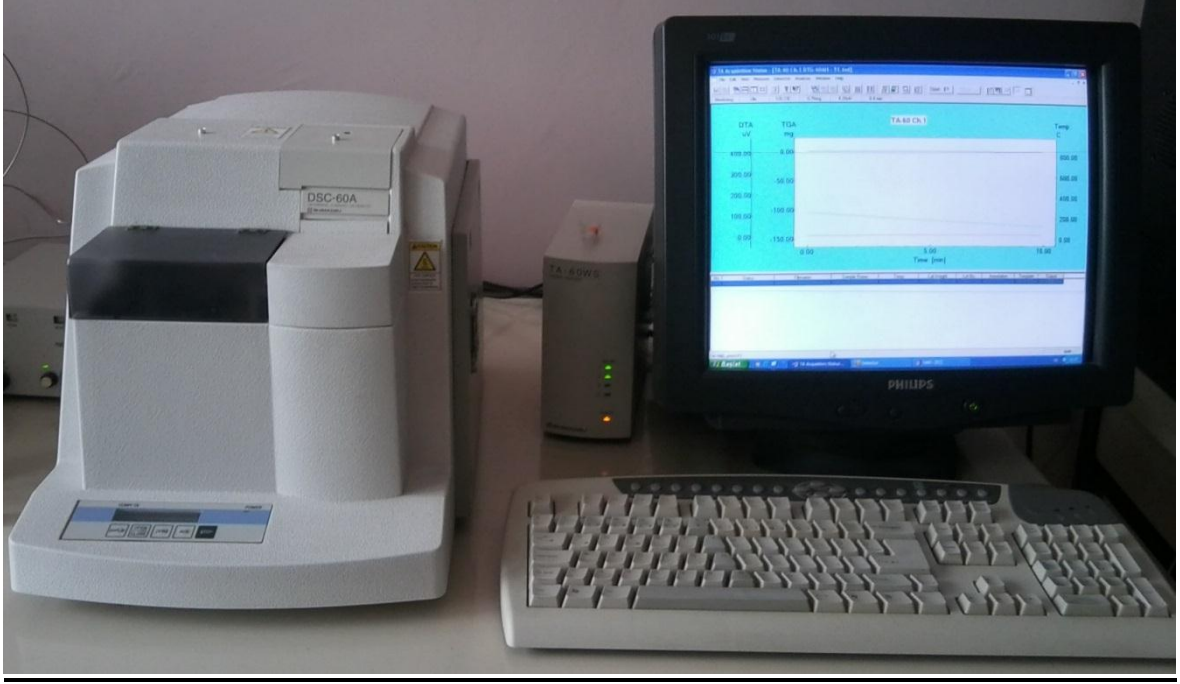
Şekil 5.5. DSC-60A Shimadzu marka DSC analiz cihazı.
