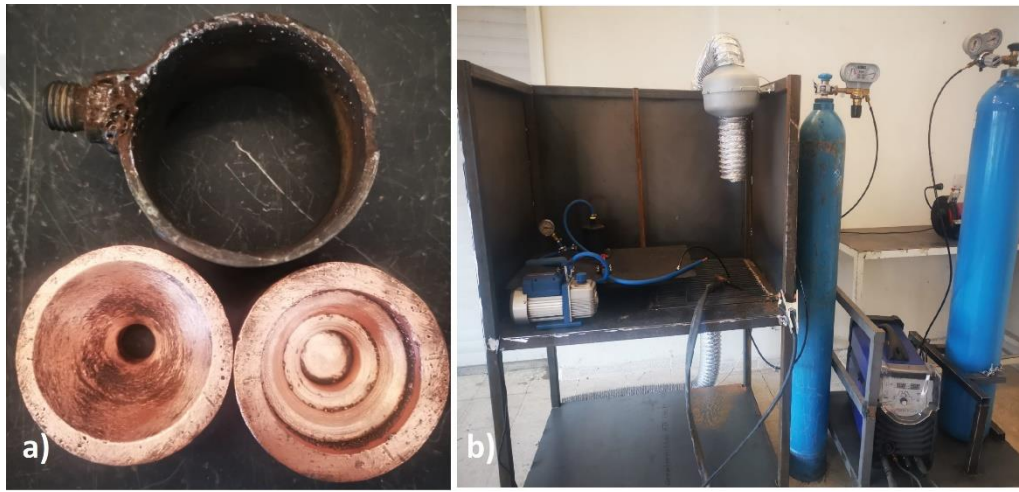
Şekil 3.3 Ergitme döküm işleminde a) bakır kalıp, b) sistem resmi.
