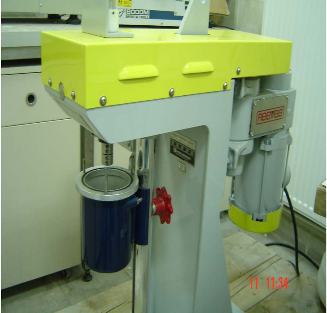
Resim 4.1. Alařım tozlarının hazırlanmasında kullanılan mekanik alařımlama /karıřtırma cihazı
