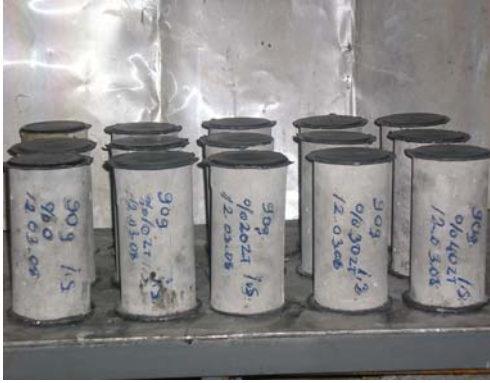
Resim 3.1. Farklı ortamlarda olgunlaştırılmış beton basınç dayanım numuneleri
