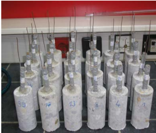
Resim 3.5. Karotla 50×100 mm boyutlarına getirilmiş betonarme silindir numuneler
