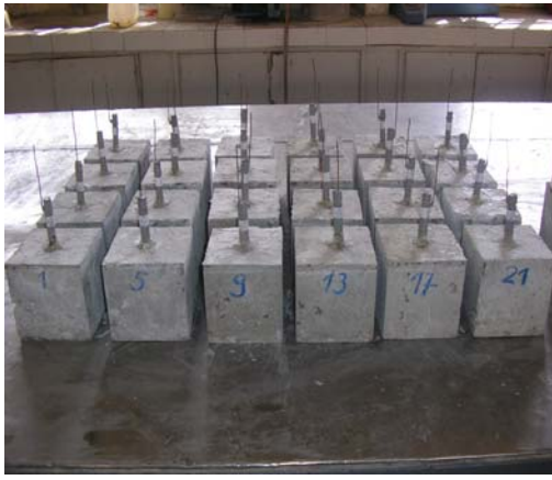
Resim 3.4. 100×100 mm boyutlarında üretilmiş betonarme küp numuneler
