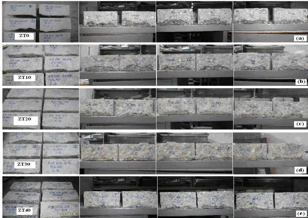
Resim 4.1. Farklı oranlarda ZT içeren betonların su işleme derinlik miktarları (a) ZT0 (b) ZT10 (c) ZT20 (d) ZT30 (e) ZT40
