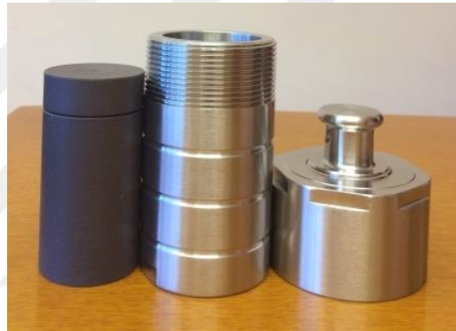
Şekil 4.9. Paslanmaz çelik hidrotermal reaktör (otoklav) (HTC)
