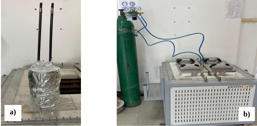
Şekil 4.6. (a) Reaktör (b) Karbonizasyon sistemi
