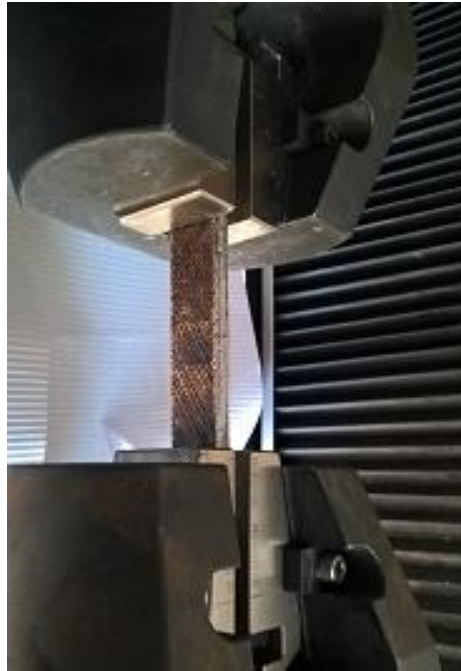
Şekil 3.5. Test numunesinin çekme cihazına bağlanması
