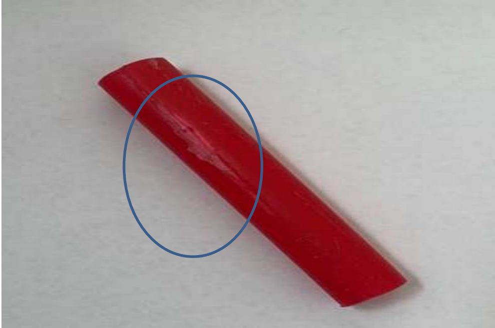
Şekil 4. 23 Buhara Maruz Kalan Numunedeki Şekil Değişimi
