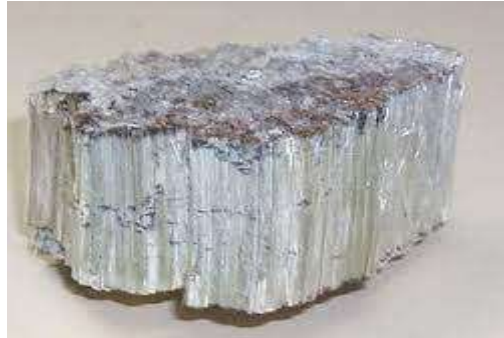
Şekil 2. 48 Asbest Lifi (Bayram 2008).
