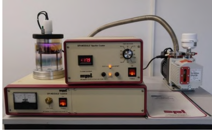
Şekil 18. \text{MgB}_2 örnek yüzeylerinin SEM analizinden önce altın ile kaplanması
