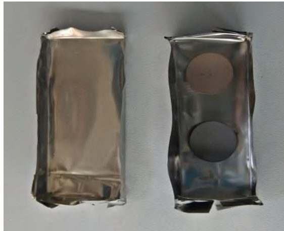
Şekil 14. Titanyum folyo hazne içine yerleştirilen MgB 2 örnekleri
