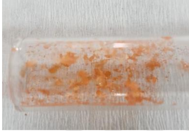
Şekil 2.2. PVT yöntemi kullanılarak büyütülmüş tek kristal rubren
