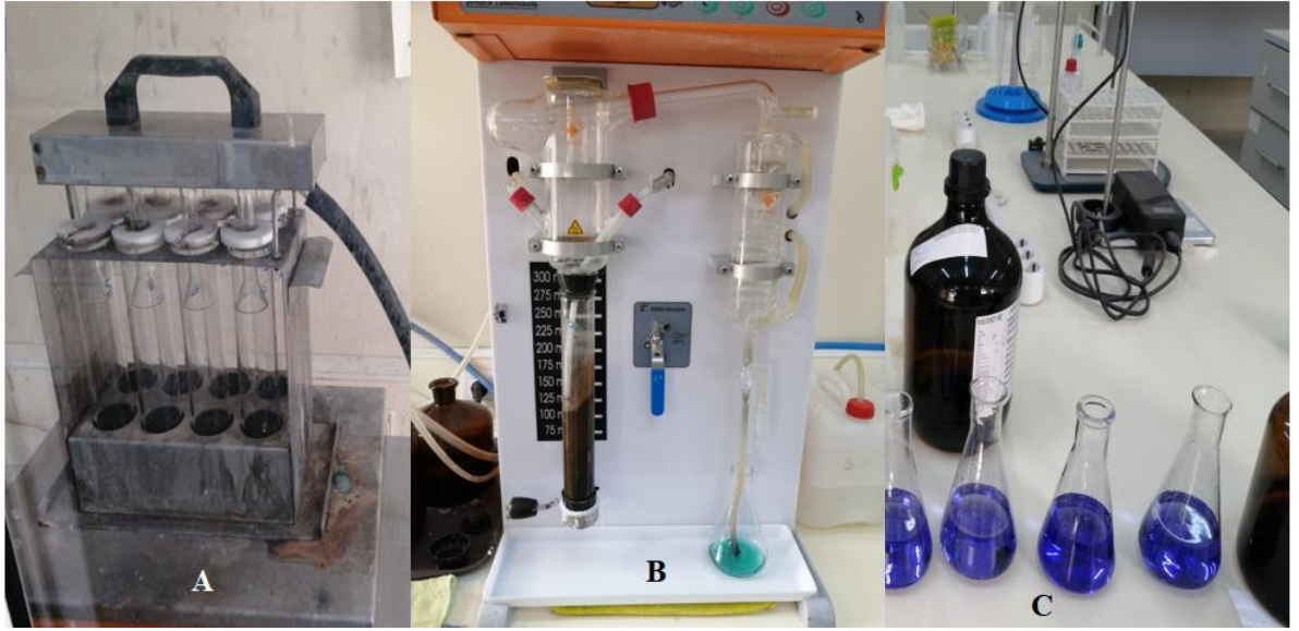
Şekil 2.3. Protein analizi yakma işlemi (A), distilasyon işlemi (B), titrasyon işlemi (C)
