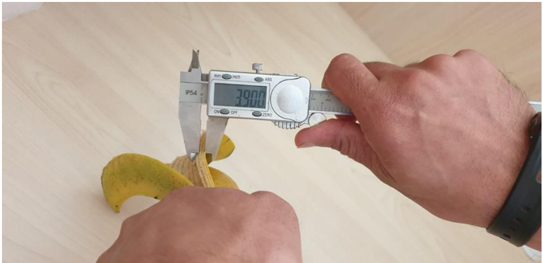
Şekil 3.12. Kabuk kalınlığı ölçümlerinden bir görünüm
