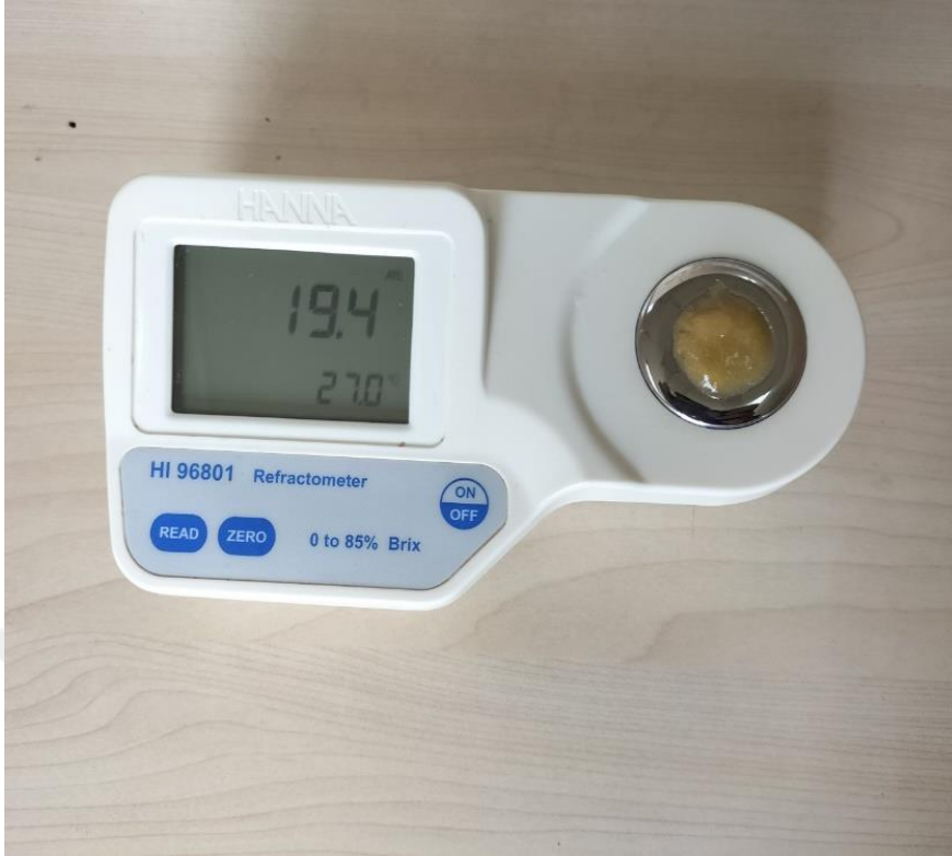
Şekil 3.14. SÇKM miktarının ölçümünde kullanılan Hanna HI 96801 dijital refraktometreden genel bir görünüm
