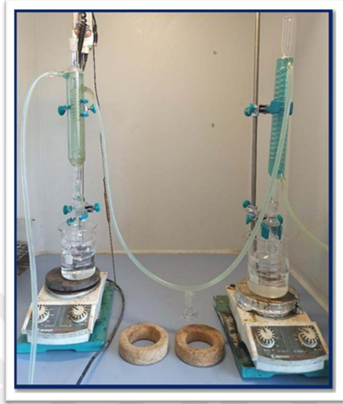
Resim 15. Hazırlanan düzende MMA monomerinin metanole geçişinin sağlanması (Ekstraksiyon düzeneği).
