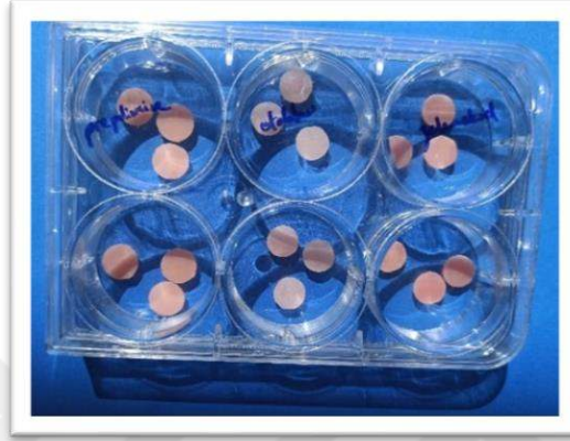
Resim 19. 6 kuyucuklu hücre üretme kabı içerisindeki PMMA rezin örnekler.
