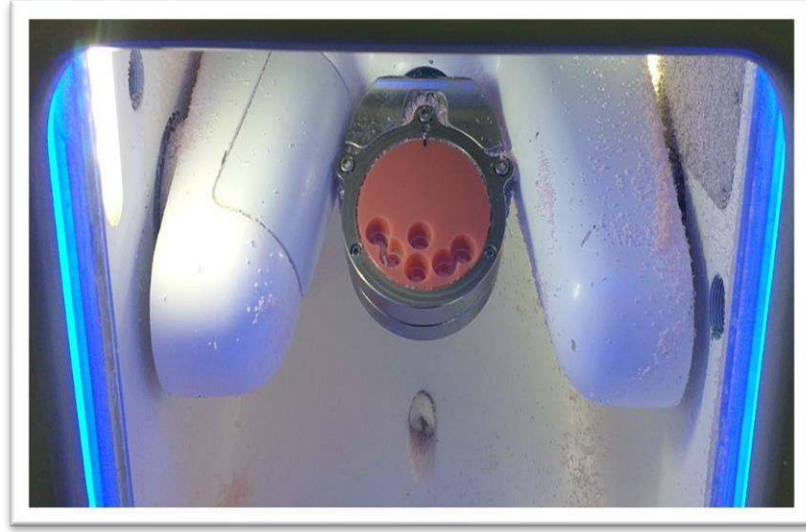
Resim 12. Kazınma işlemleri tamamlanmış akrilik blok.
