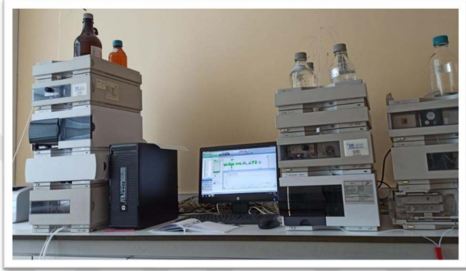
Resim 17. Çalışmamızda kullanılan Agilent 1100 HPLC cihazı.
