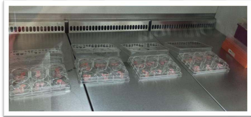
Resim 20. Laminar flow kabin içerisinde 6 kuyucuklu hücre üretme kapları içerisindeki PMMA rezin örnekler
