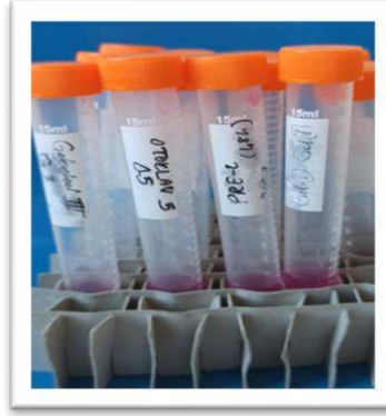
Resim 23. PMMA rezin örneklerin salınım ekstraktlarının koyulduğu steril tüpler.
