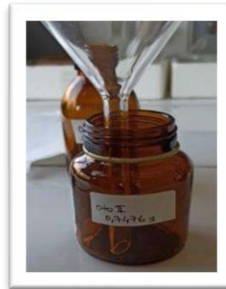
Resim 16. Artık monomer deneyi için hazırlanan solüsyonların karanlık şişelere yerleştirilmesi.
