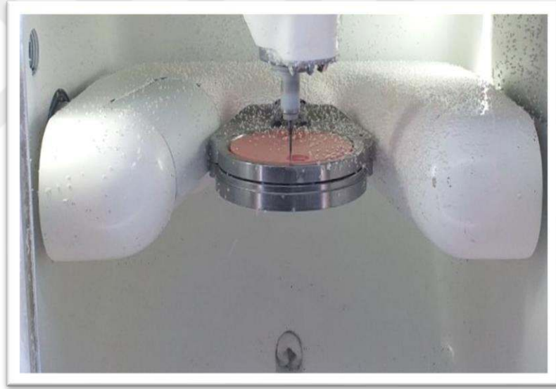
Resim 11. Prepolimerize akrilik diskin Redon GTR cihazı ile kazınması.
