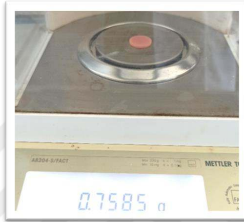
Resim 14. Örneklerin hassas terazi ile tartılması.
