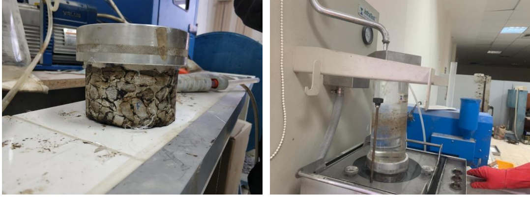
Şekil 3.26. Yatay permeabilite deneyi; a) O-ringin numunenin üzerine monte edilmesi; b) Numunenin üzerinden suyun akıtılması
