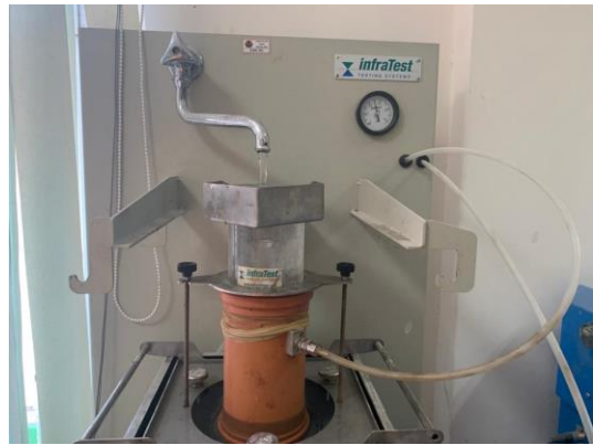
Şekil 3.25. Düşey permeabilite deneyi; a) Membranın hava ile şişirilmesi; b) Numunenin üzerinden suyun akıtılması
