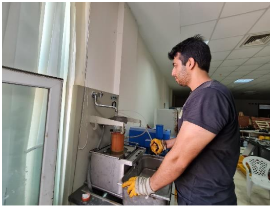
Şekil 3.25. Düşey permeabilite deneyi; a) Membranın hava ile şişirilmesi; b) Numunenin üzerinden suyun akıtılması
