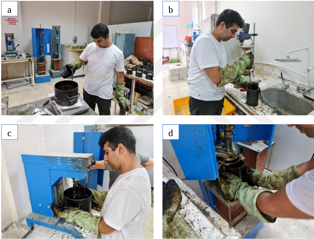
Şekil 3.13. PA Marshall numunelerinin hazırlanması; a) Isıtılmış malzemelerin karışım kabına ilave edilmesi; b) Mikserde malzemelerin karıştırılması; c) Karışımın 25 defa şişlenmesi; d) Marshall kompaktörde karışımın sıkıştırılması
