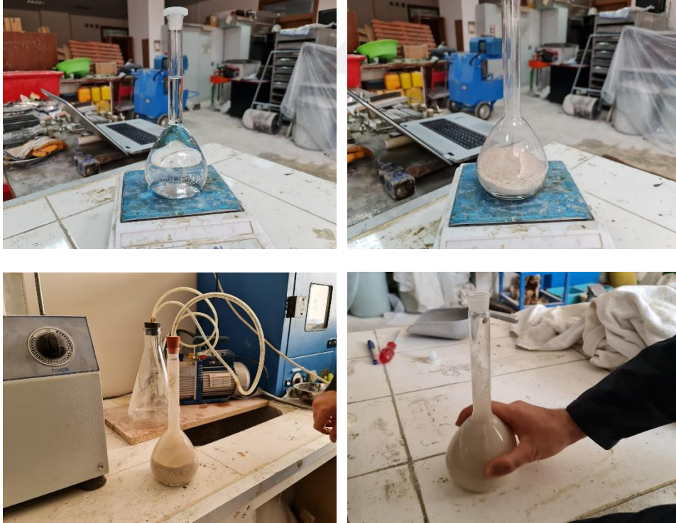
Şekil 3.4. Filler özgöl ağırlık deneyi; a) Piknometrenin saf su ile doldurulması; b) Piknometreye fillerin koyulması; c) Piknometreden havanın vakumlanıp çıkarılması; d) Piknometreye eksik suyun tamamlanması
