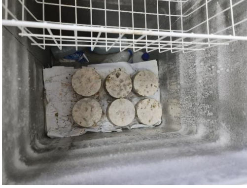
Şekil 3.24. Donma çözülme deneyi, -18°C'de bekletilen YEK numuneleri
