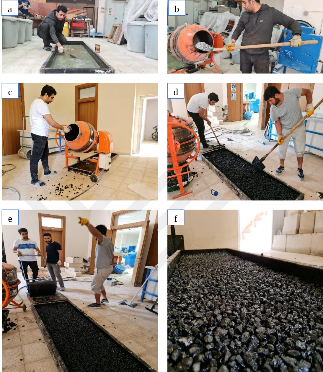
Şekil 3.17. Poroz asfalt karışımının yapım aşamaları; a) PA karışımı dökülecek kalıbın kurulup yağlanması; b) PA karışımını oluşturan malzemelerin miksere ilave edilmesi; c) karıştırma işlemi boyunca sıcaklığın kontrol edilmesi; d) Dökme işleminden sonra PA karışımının tırmıkla yayılması; e) El silindiri yardımıyla karışımın sıkıştırılması; f) PA yüzeyi
