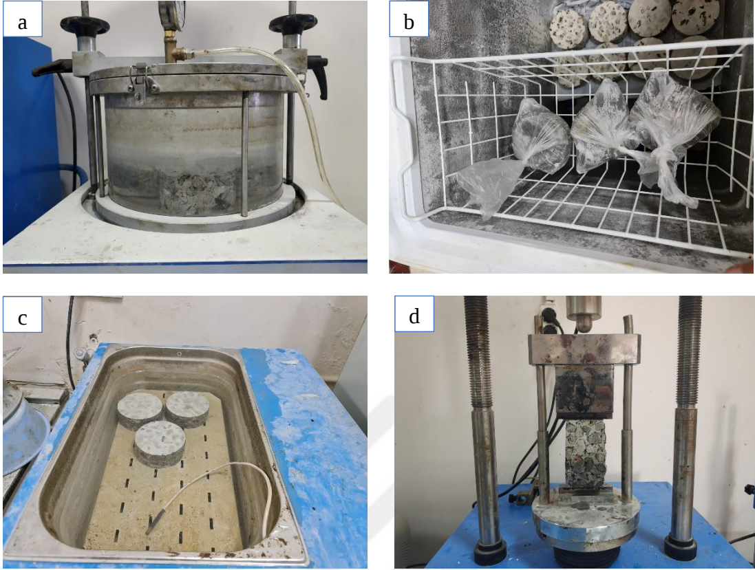
Şekil 3.23. Nem hasarına karşı direnç deneyi; a) Vakumlu desikatöre yerleştirilmiş YEK numuneleri b) -18°C derecede bekletilen YEK numuneleri; c) 60°C derecede bekletilen YEK numuneleri; d) İndirekt çekme mukavemeti deneyi
