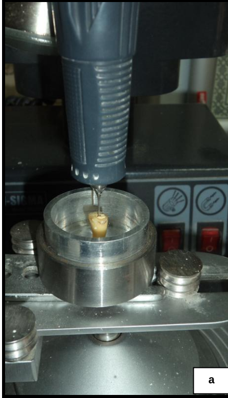
Resim 4a. Post yuvası açmada kullanılan frezin kanala ve diğer ucunun paralelometreye bağlanması, 4b. Köklerin akrilik rezin içerisine gömülmesi.
