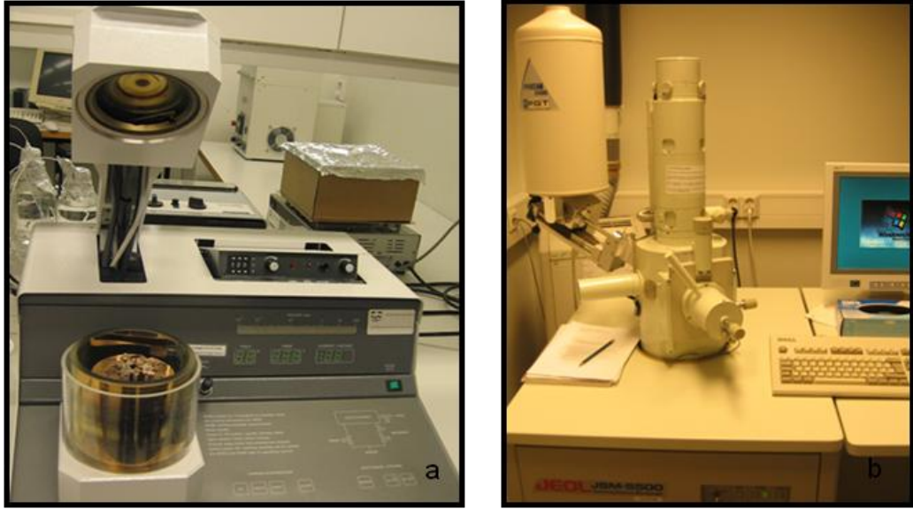
Resim 28. a. Örneklerin kaplanması, b. SEM cihazı.
