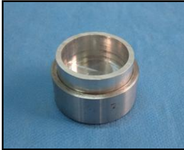
Resim 3. Dişlerin akrilik bloğa gömülmesinde kullanılan metal kalıp.
