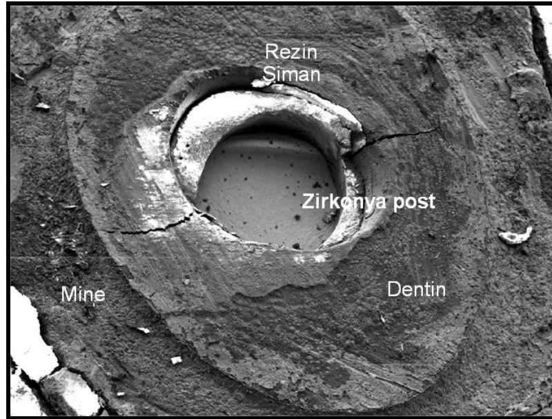
Resim 47. Grup 8’de görülen postun servikal marjinin 2 mm altından kırıldığı kırık tipinin SEM görüntüsü (x300 büyütme).
