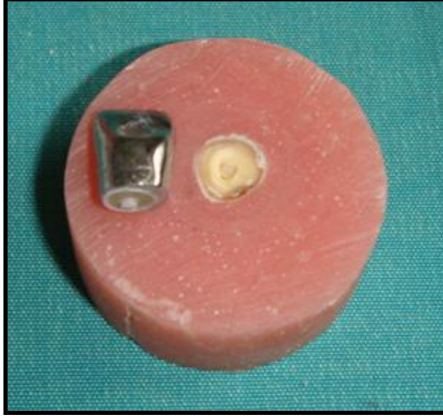
Resim 32. Grup 5 (10 mm uzunluğunda zirkonya post ve zirkonya kor)'deki örneklerde % 100 oranında servikal marjinin 2 mm altından kırılma gözlemlendi.
