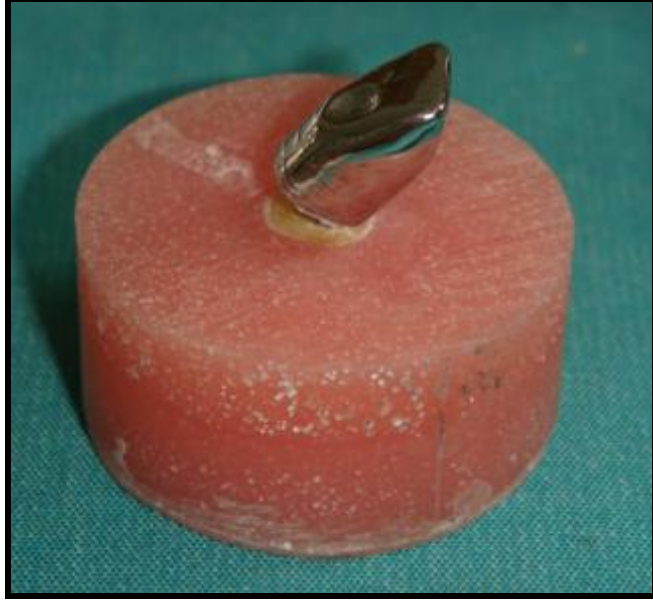
Resim 30. Grup 2 (10 mm uzunluğunda fiber post ve kompozit rezin kor materyali) 'deki örneklerde % 90 oranında kanaldan uzaklaşma gözlemlendi.
