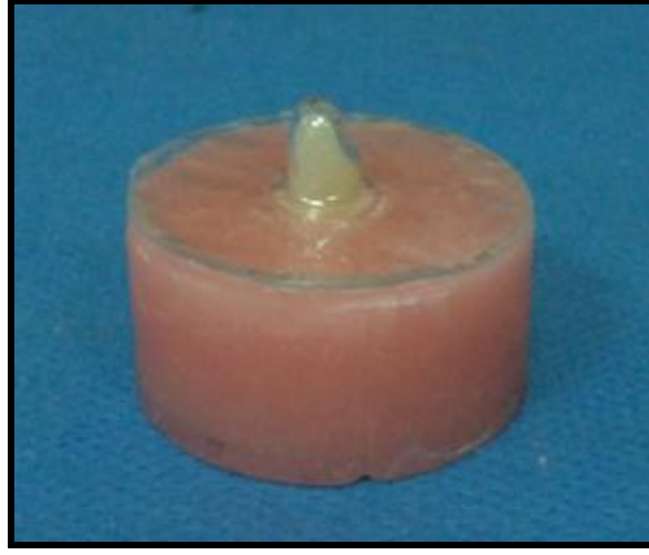
Resim 18. Korların hazırlanmasından kullanılan metilmetakrilat akrilik kalıp.
