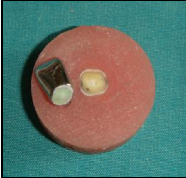
Resim 39. Grup 9 (15 mm uzunluğunda zirkonya post ve kompozit rezin kor materyali)'daki örneklerde % 40 oranında servikal marjinin 2 mm üzerinden kırılma gözlendi.
