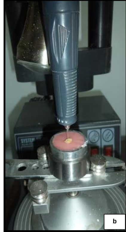
Resim 4a. Post yuvası açmada kullanılan frezin kanala ve diğer ucunun paralelometreye bağlanması, 4b. Köklerin akrilik rezin içerisine gömülmesi.
