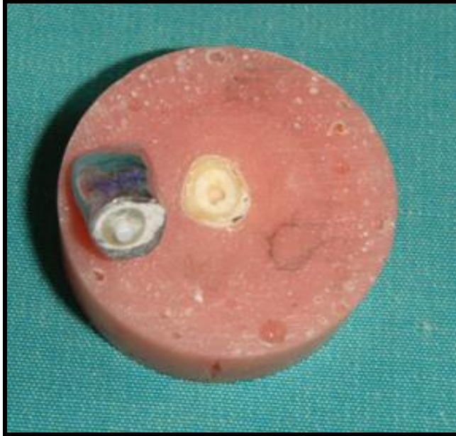
Resim 37. Grup 10 (15 mm uzunluğunda zirkonya post ve zirkonya kor)'daki örneklerde % 100 oranında servikal marjinin 2 mm altından kırılma gözlendi.
