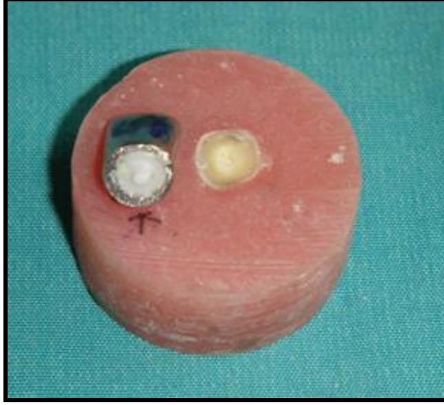
Resim 38. Grup 5 (10 mm uzunluğunda zirkonya post ve zirkonya kor)'deki örneklerde % 100 oranında servikal marjinin 2 mm altından kırılma gözlendi.
