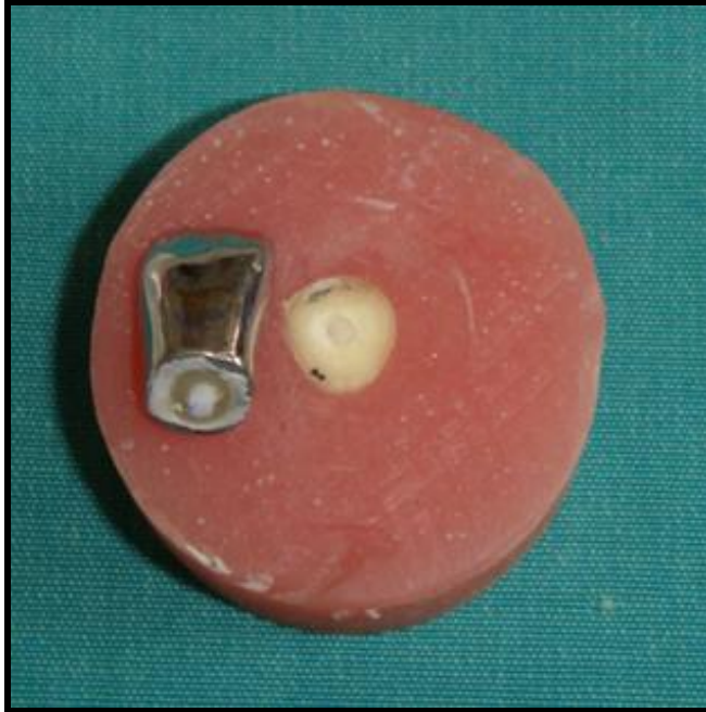
Resim 35. Grup 8 (15 mm uzunluğunda zirkonya post ve kompozit rezin restoratif materyal)'deki örneklerde % 100 oranında servikal marginin 2 mm altından kırılma gözlemlendi.
