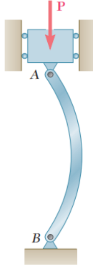
Şekil 3.2. Yük uygulandıktan sonra burkulma mekanizmasının genel gösterimi [1]
