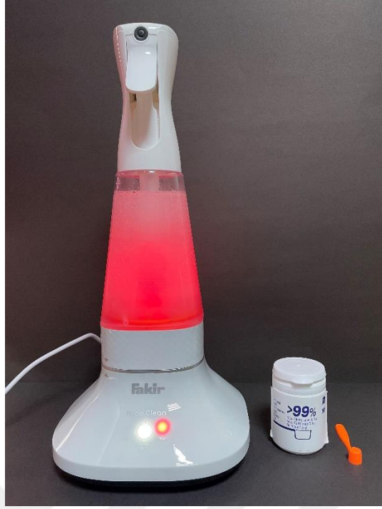
Resim 15. Elektrolize su cihazı ierisine su ve rafine tuzun koyulup alıřtırılması
