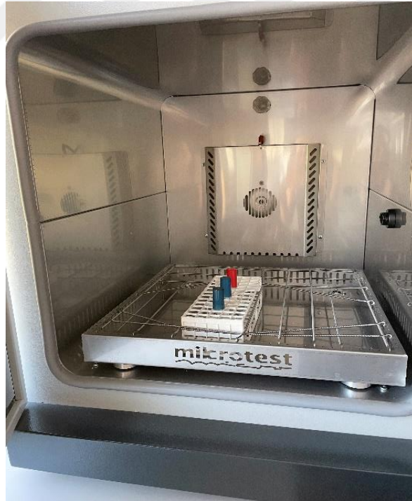
Resim 20. Sıvı besiyerine ekilen mikroorganizmaların 37°C de 24 saat sallayıcı etüvde inkübasyona bırakılması
