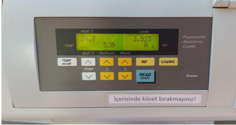
Resim 23. Süspansiyonun spektrofotometrede ölçümünün alınması
