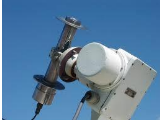
Şekil 3. 17 Güneş takip sistemine monte edilmiş pirheliometre
