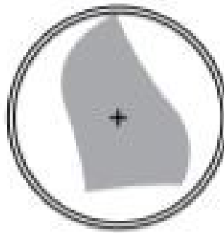
Şekil 23: One-G rehber yol eęe sisteminin uç kesiti
