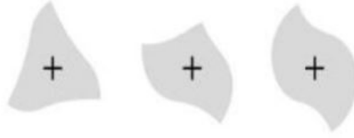
Şekil 10: One Shape Ni-Ti döner alet sisteminin asimetrik kesimi
