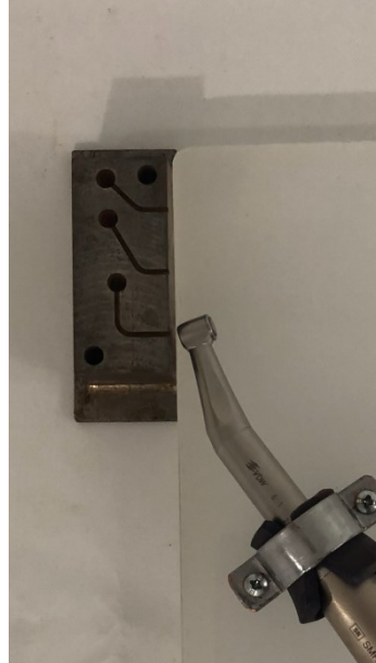
Şekil 29: Eğim açısı 90^0 olan yapay kanala eğenin yerleştirilmesi
