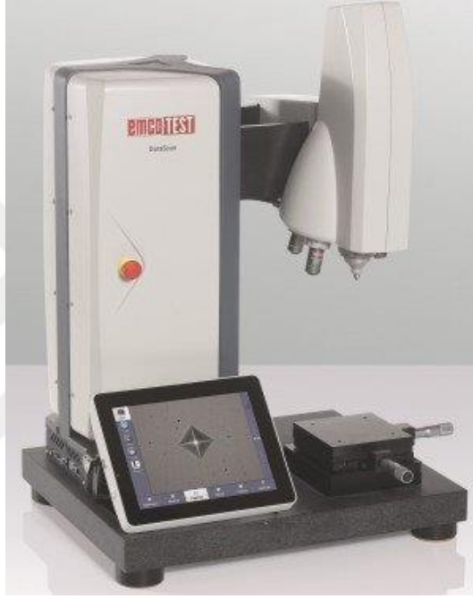
Resim 11. Mikrosertlik ölçüm cihazı (DuraScan G5, emcoTEST, Kuchl, Avusturya).
