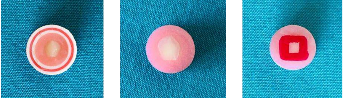
Resim 4. Örneklerin plastik çerçeve içinde akrile gömüldükten sonra,, zımparalama işleminden sonra ve aside dayanıklı tırnak cilası ile 3x3 mm'lik çalışma alanının belirlenmesinden sonraki görüntüleri.
