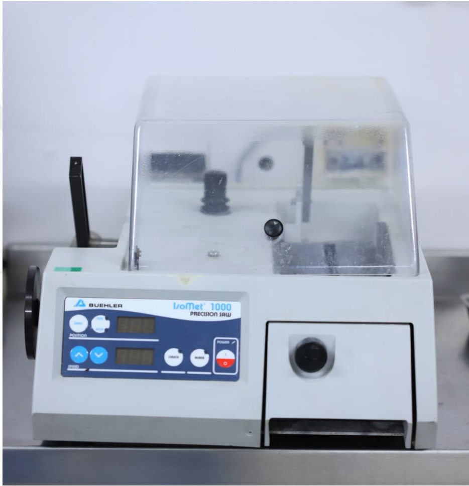
Şekil 3-2: Isomet 1000 hassas kesme cihazı (Buehler Ltd., Lake Bluff, IL, ABD)
