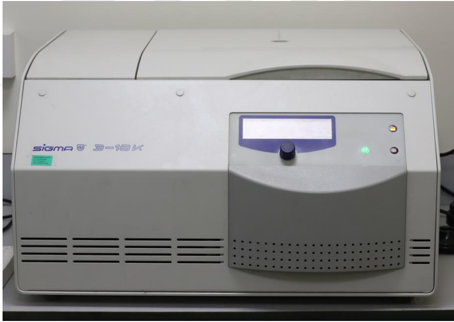
Şekil 3-22: Soğutmalı santrifüj (3-18K, Sigma, Almanya)
