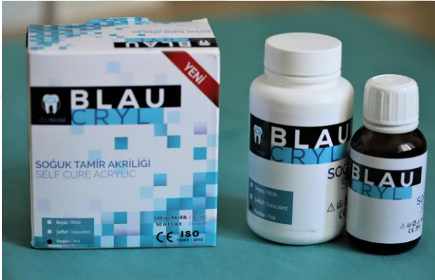
Şekil 3-4: Örneklerin gömüldüğü akrilik reçine
