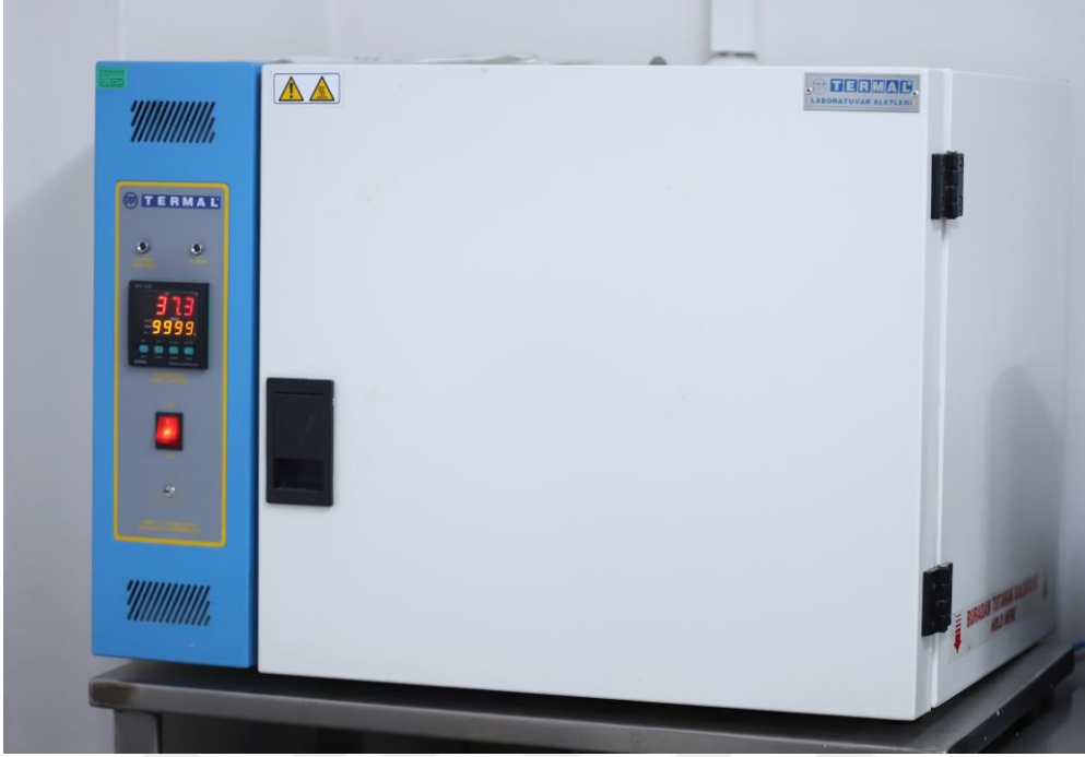
Şekil 3-12: Çalışmada kullanılan etüv (Termal Laboratuvar Aletleri, İstanbul, Türkiye)
