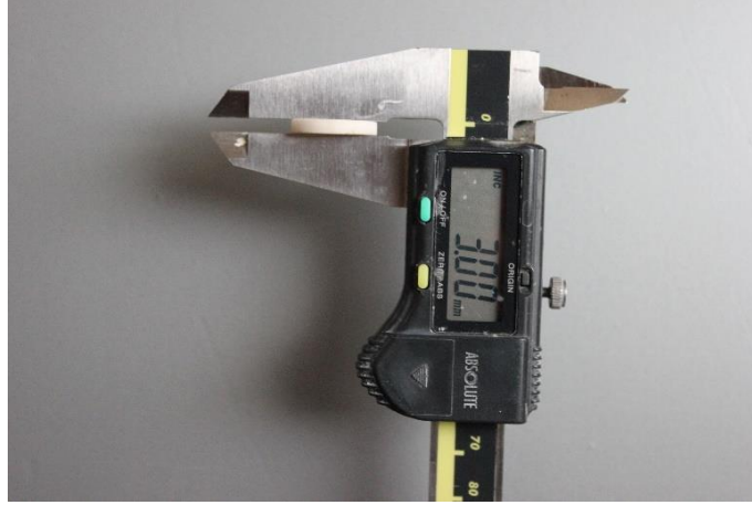
Şekil 3.9. Örnek kalınlığının dijital kumpasla ölçümü
