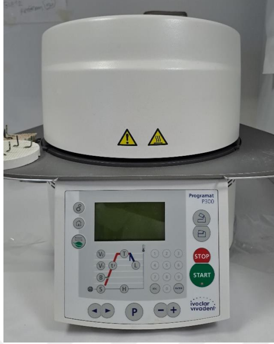
Şekil 3.2. Seramik örnekleri pişirmede kullanılan fırın makinesi
