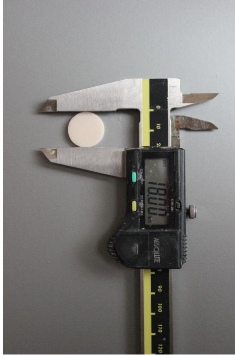
Şekil 3.8. Örnek çapının dijital kumpasla ölçümü
