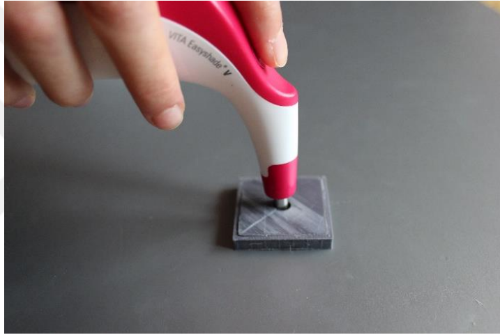
Şekil 3.13. Örneklerin spektrofotometre ile renk ölçümleri
