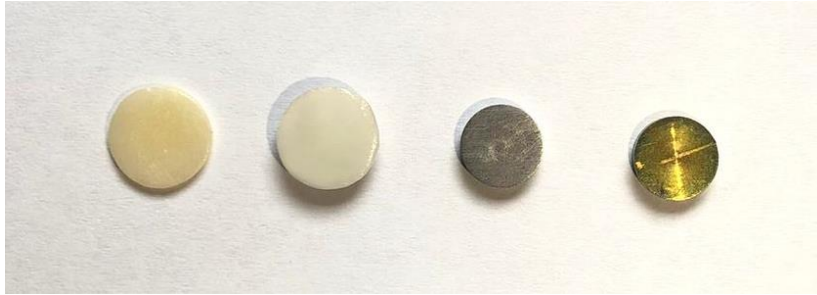
Resim 15. Sırası ile; zirkonya, hibrit, titanyum, anodize titanyum dayanak örnekleri
