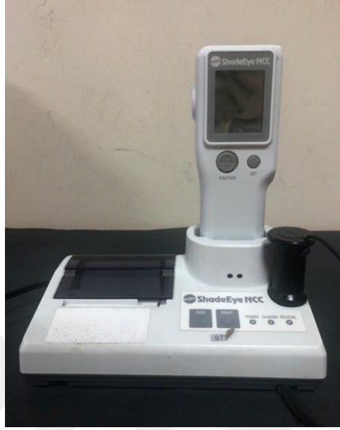
Resim 21. Shofu firmasının ShadeEye NCC Kolorimetre cihazı
