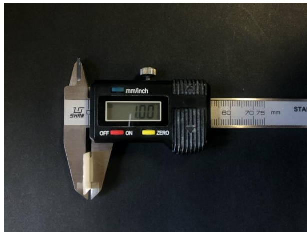
Resim 11. Sinterizasyon ve polisaj işlemleri sonrasında örnek kalınlıklarının ölçülmesi
