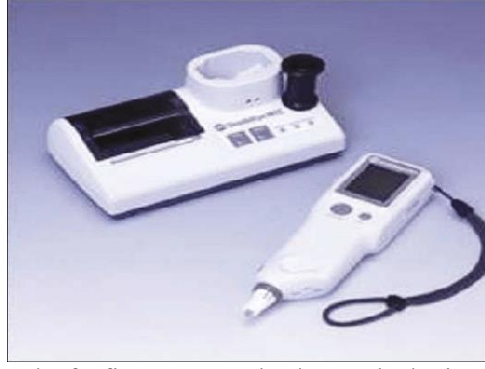
Resim 4. Shofu firmasının ShadeEye kolorimetre cihazı
