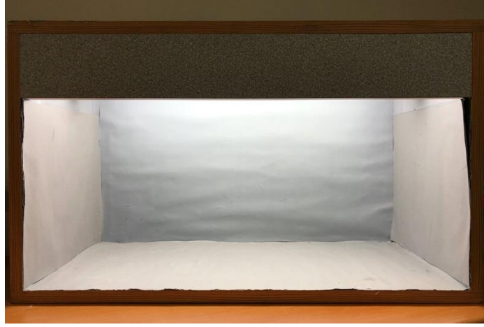
Resim 23. Renk ölçüm kutusu (viewing booth)
