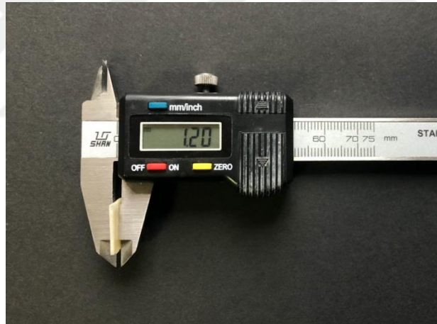
Resim 28. Rezin siman uygulanmış örneklerin kalınlıklarının ölçülmesi
