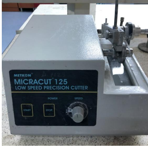
Resim 7. Microcut 125 kesim cihazı
