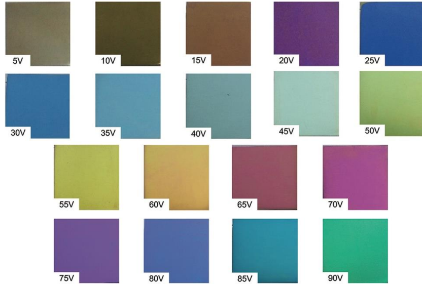
Şekil 4. Farklı voltajlarda anodik oksidasyon uygulanmış titanyum örneklerde oluşan renkler (103).
