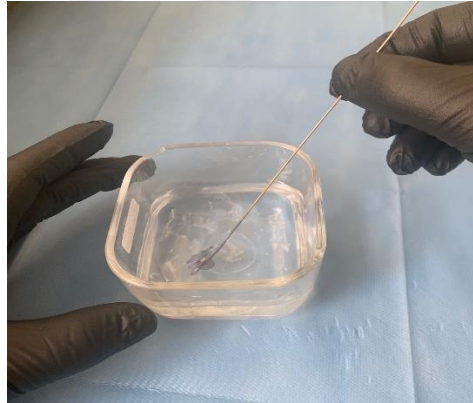
Resim 17. Örneğin dağlama sıvısına daldırılması
