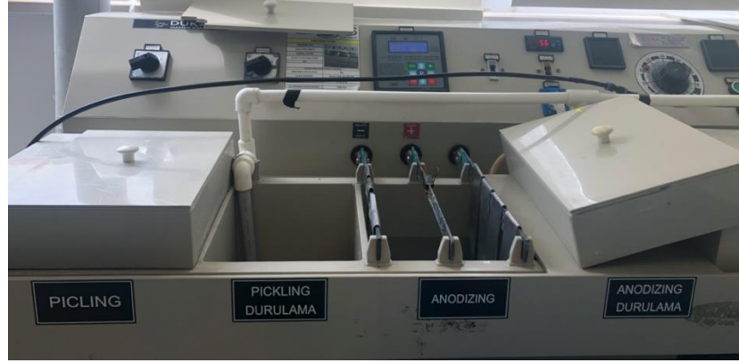
Resim 16. Anodizasyon Uygulama Cihazı (Implance Medikal AGS, Trabzon, Türkiye)
