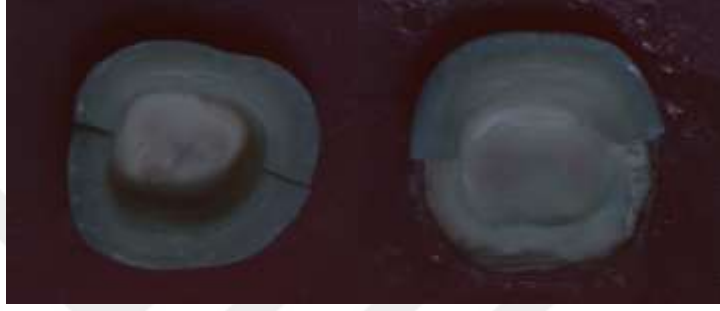
Şekil 39. Tip IV kırılma.
