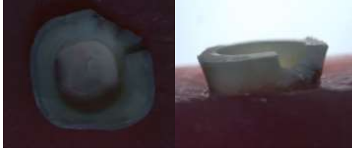
Şekil 38. Tip III kırılma.
