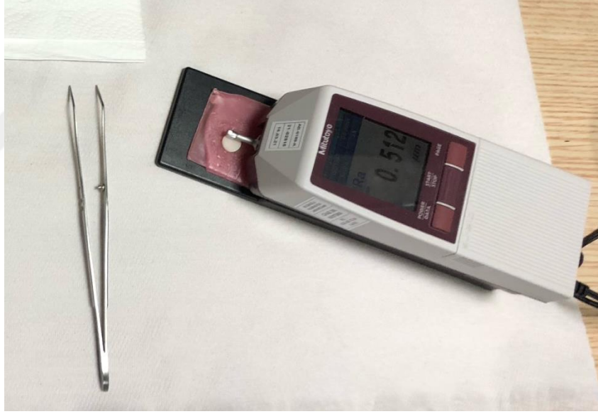
Şekil 3.11. Mekanik profilometre ile bir numuneden yüzey pürüzlülüğü ölçümü
