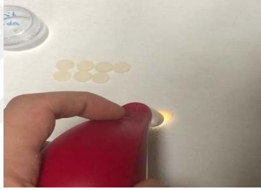
Şekil 3.19. Vita Easyshade V ile Renk Ölçümü
