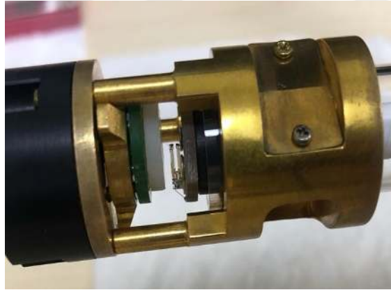
Şekil 3.13. AFM Cihazına Numunenin Yerleştirilmesi
