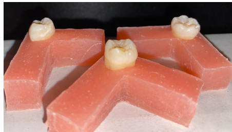
Şekil 3.3.1 Akrilik rezin içerisine gömülen dişler
