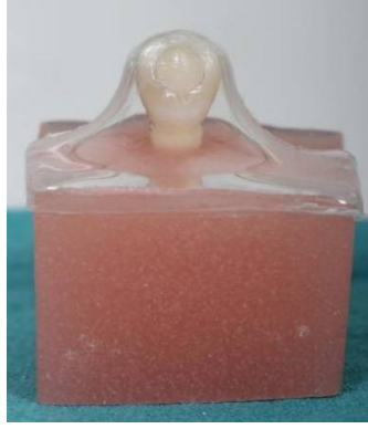
Resim 3.14. Pürüzlülüğü incelenecek mine yüzeyini standardize etmek amacı ile hazırlanan plastik kılıf.
