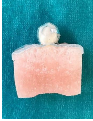
Resim 3.15. SEM ile incelenecek dişin iletkenliğini sağlamak amacı ile yerleştirilen alüminyum kâğıt.
