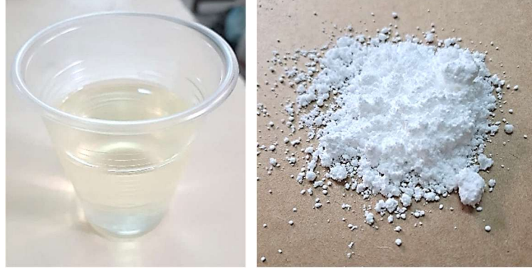
Şekil 3.4 Elüm reçine ve dibenzoil peroksit sertleştirici
