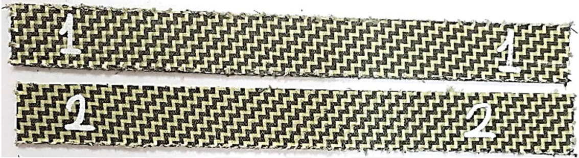
Şekil 3.13 Çekme numunesi örnekleri
