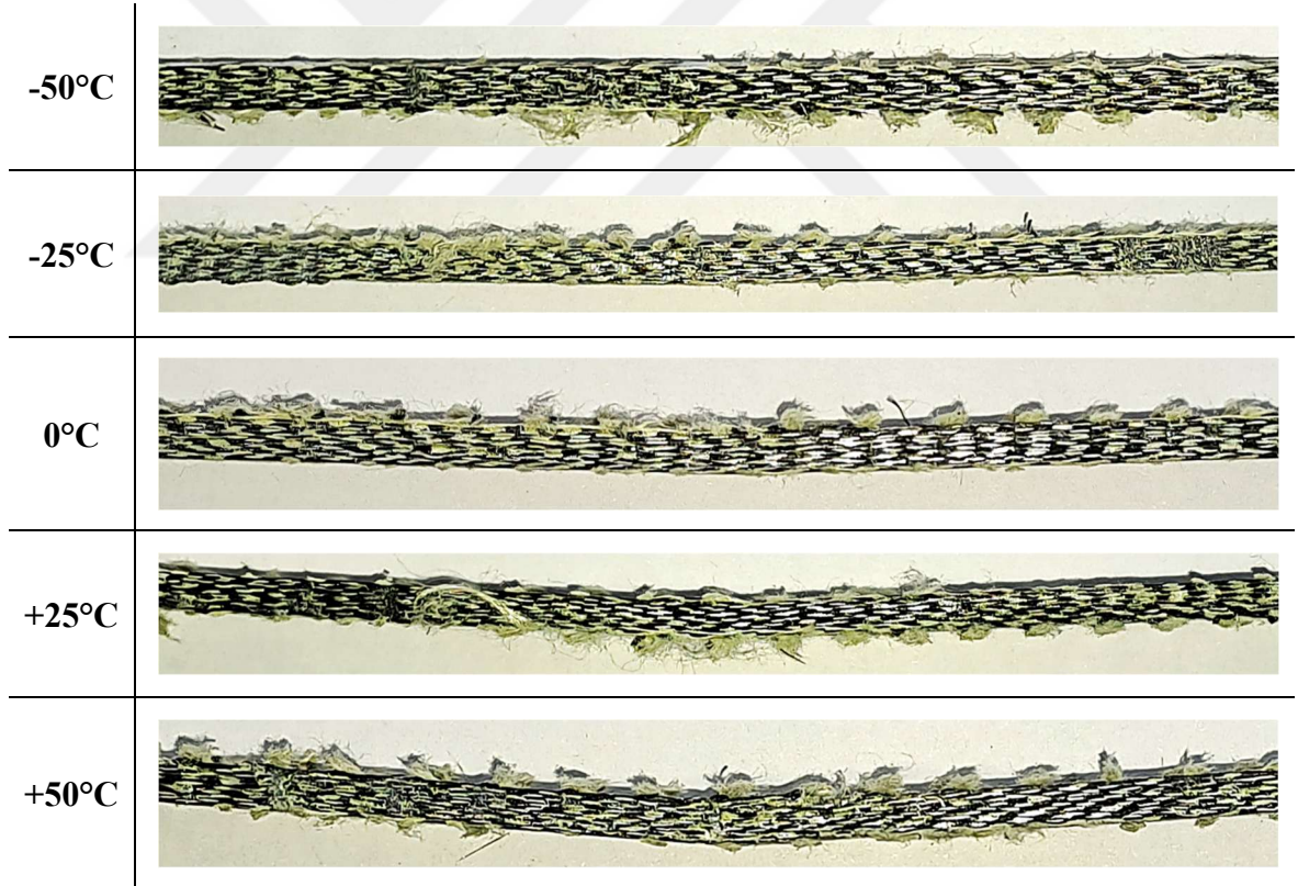
Şekil 4.10 Test sıcaklığına göre eğilme testi sonrası makro hasar görüntüleri
