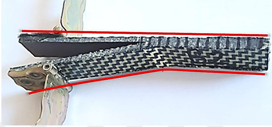
Şekil 3.27 Başarısız DCB test deneme örneği
