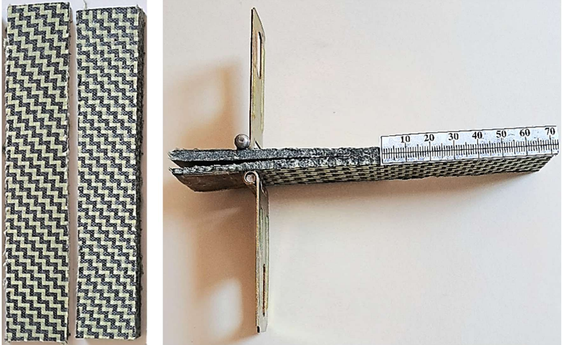
Şekil 3.26 DCB numunesi örnekleri
