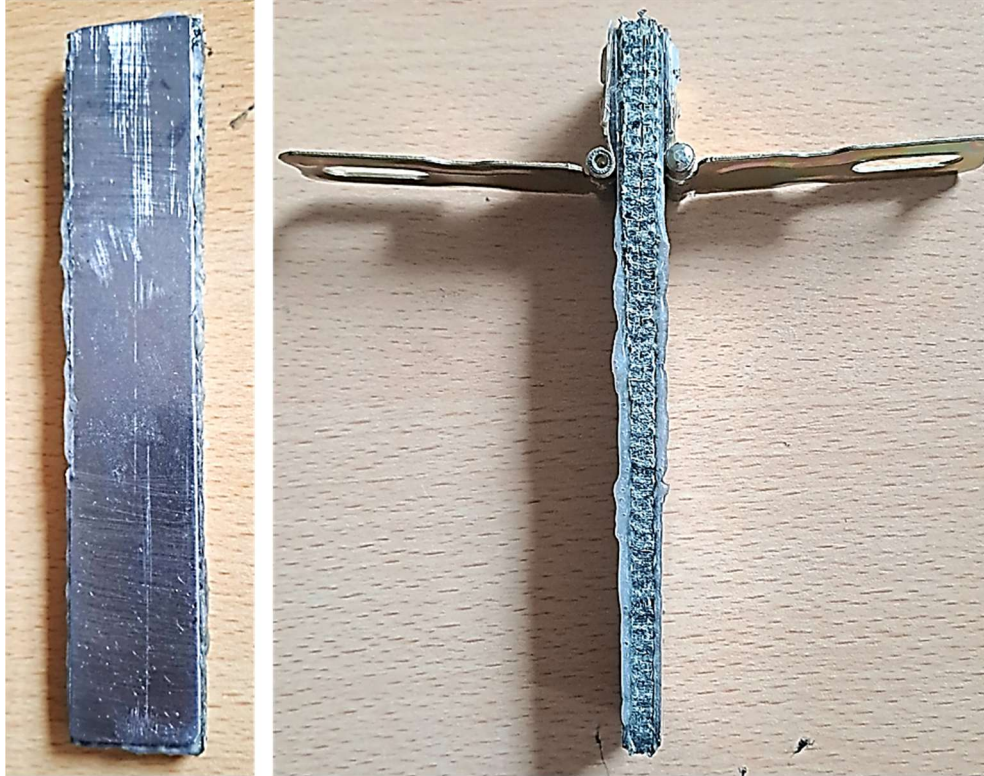
Şekil 3.28 Revize edilmiş DCB numunesi
