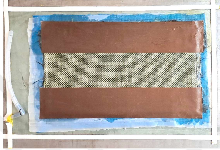
Şekil 3.10 Çift ankastre kiriş testi için numune üretiminin yapılması
