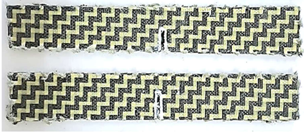
Şekil 3.20 SENB numunesi örnekleri
