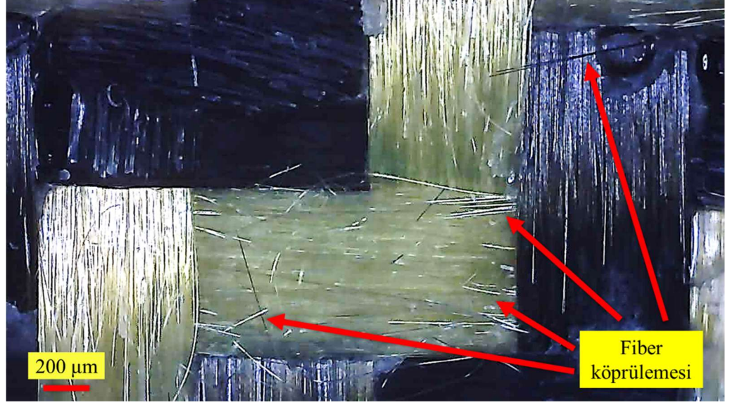
Şekil 4.41 Yaşlandırma süresine göre DCB testi sonrası makro hasar görüntüleri (devamı)
