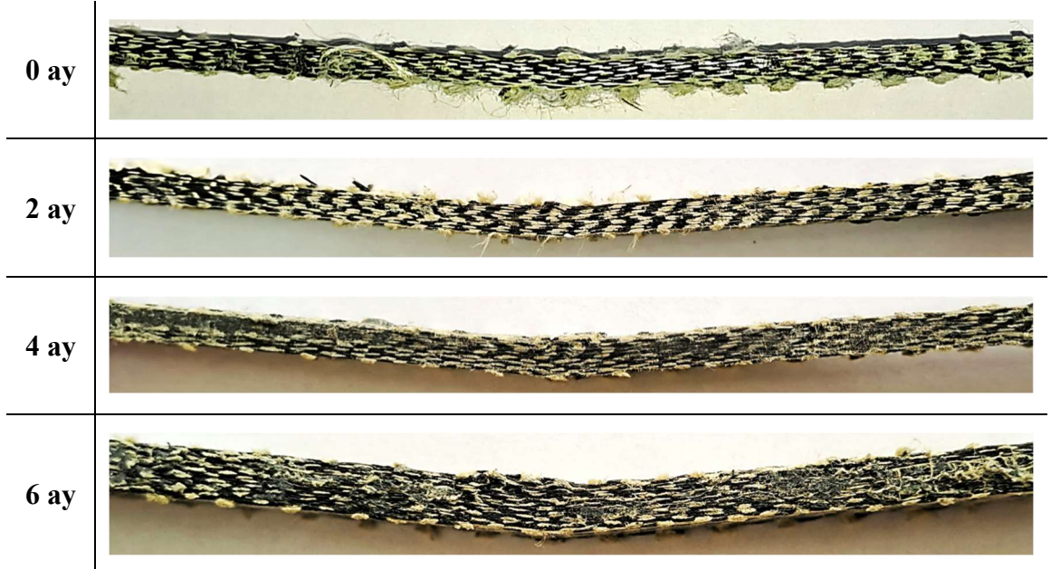
Şekil 4.30 Yaşlandırma süresine göre eğilme testi sonrası makro hasar görüntüleri
