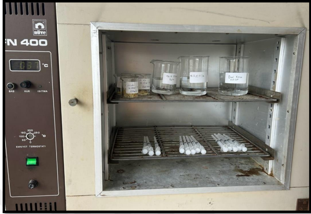
Resim 11: 37 °C’de (vücut sıcaklığında) etüvde bekletilen solüsyonlar ve dişler
