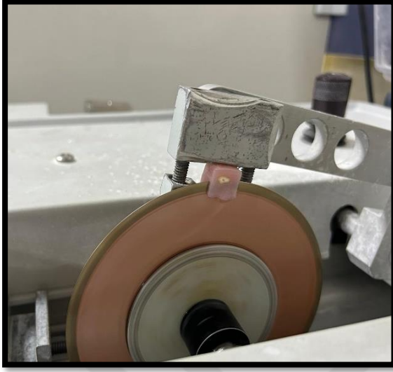
Resim 20: İsoMet cihazı ve kesit alma işlemi
