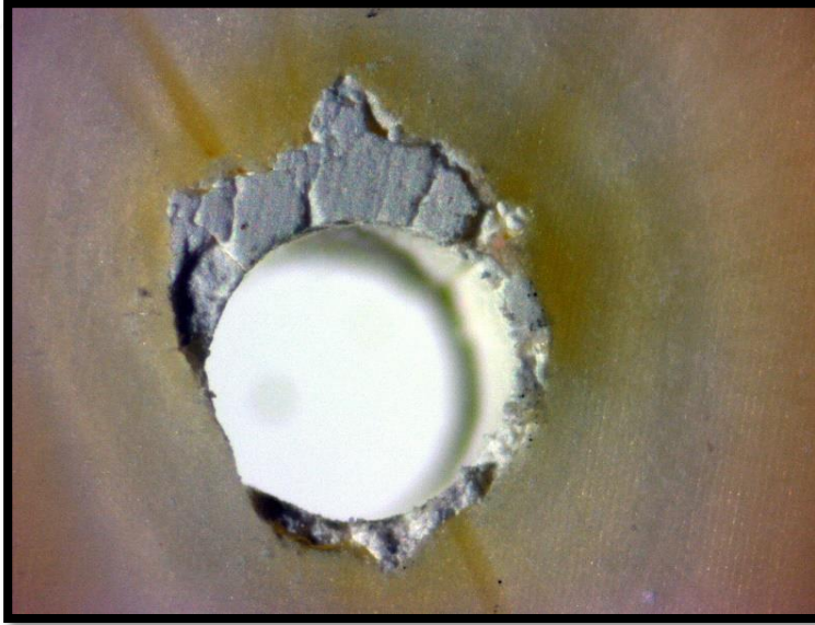
Resim 27: Karışık tip bağlantı başarısızlığının stereomikroskop görüntüsü
