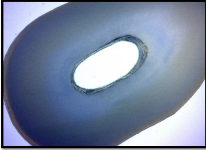
Resim 26: Adeziv tip bağlantı başarısızlığının stereomikroskop görüntüsü
