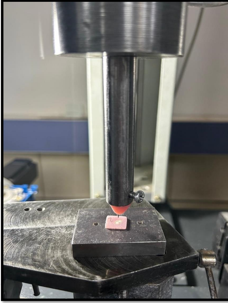
Resim 23: Örneklere itme bağlanma dayanımı testinin uygulanması
