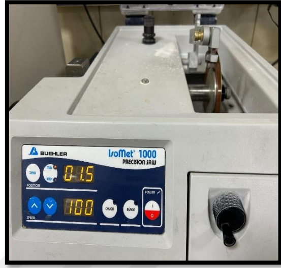
Resim 20: İsoMet cihazı ve kesit alma işlemi
