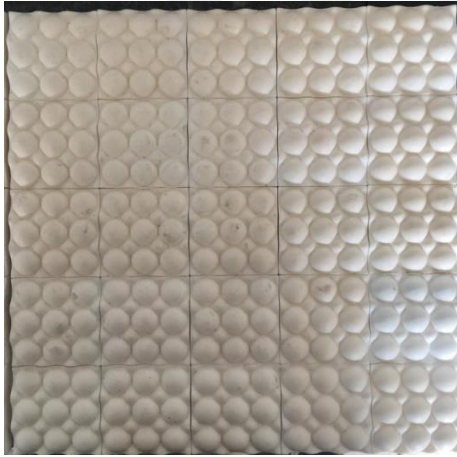
Şekil 3.13: Alümina numunelerin tek saca yapıştırılmış hali
