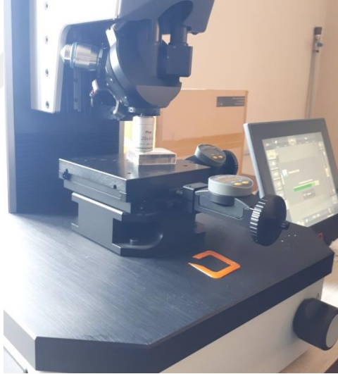
Şekil 3.11: Seramik numuneye sertlik testi uygulanışı
