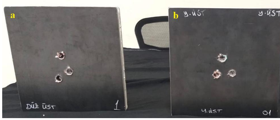
Şekil 4.6: Zırh numunelerine ateş edildikten sonra ön görüntüsü
