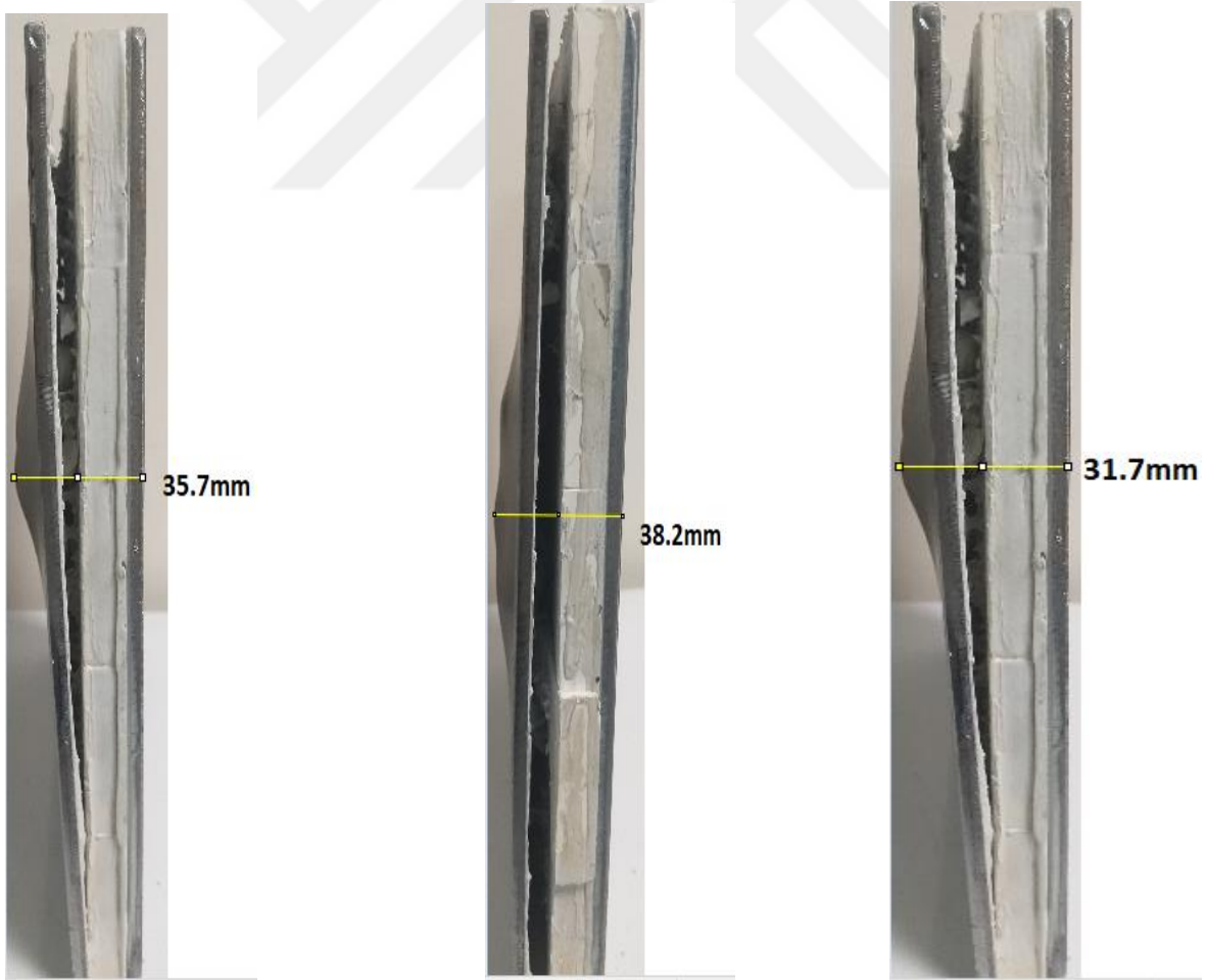
Şekil 4.13: Düz geometrili seramik zırhta merminin yaptığı bombe ölçümü
