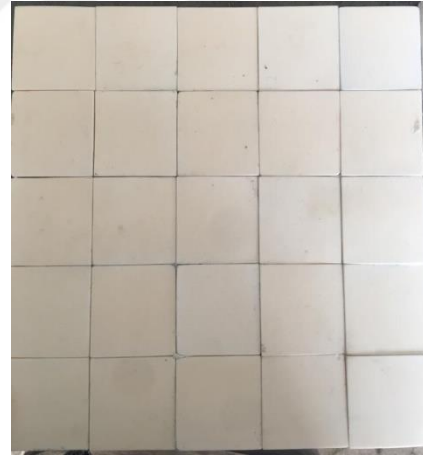
Şekil 3.13: Alümina numunelerin tek saca yapıştırılmış hali
