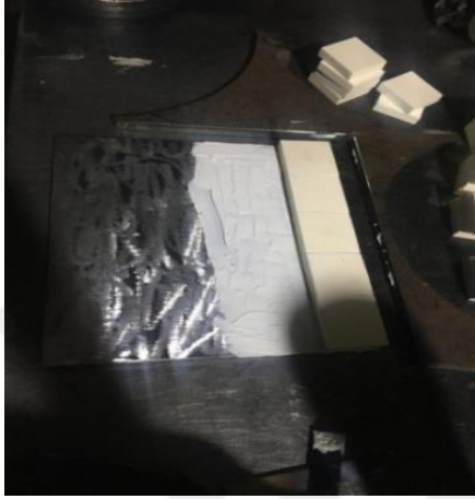
Şekil 3.12: 2 Farklı alümina numunelerin saca yapıştırılması
