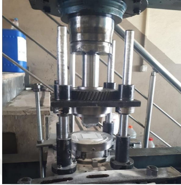
Şekil 3.8: Kalıpların prese bağlanması hali
