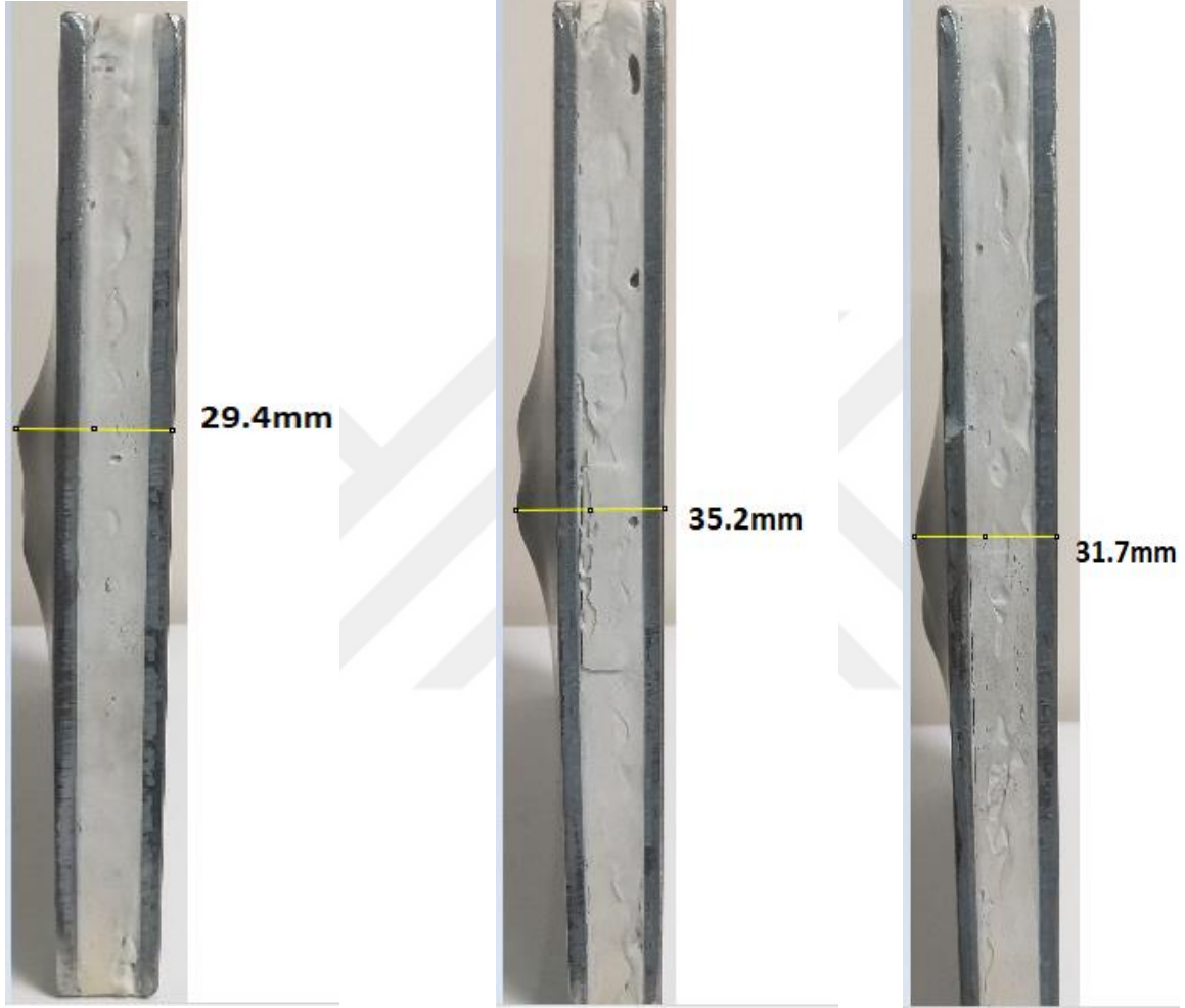
Şekil 4.14: Yuvarlak geometrili seramik zırhta merminin yaptığı bombe ölçümü
